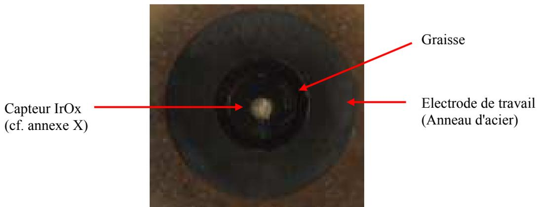
*Fig. 3.15: Photographie de la surface de l'arrangement capteur / électrode*
