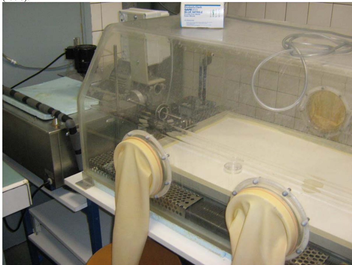
Figure 1a Système d'incubation de type « boîte à gant » développé par Graulet et coll. (1998).
