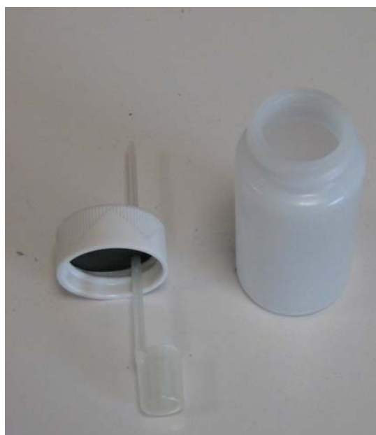
Figure 1b Flacon muni d'une nacelle utilisé pour la mesure de l'oxydation du propionate [ 1\text{-}^{14}\text{C} ] et de l'alanine [ \text{U-}^{14}\text{C} ].
