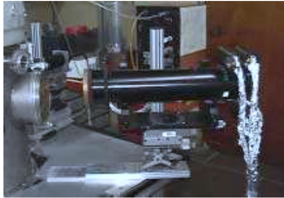
Photo 1: Sonde de détection munie de trois photomultiplicateurs
