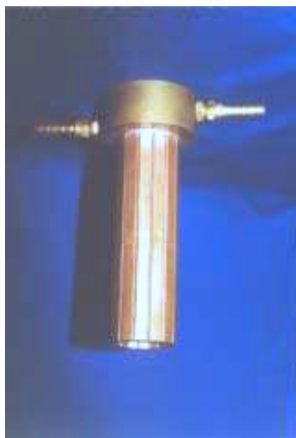
Photo 1: Applicateur plasma de type cage froide refroidi à l'eau et optiquement étanche
