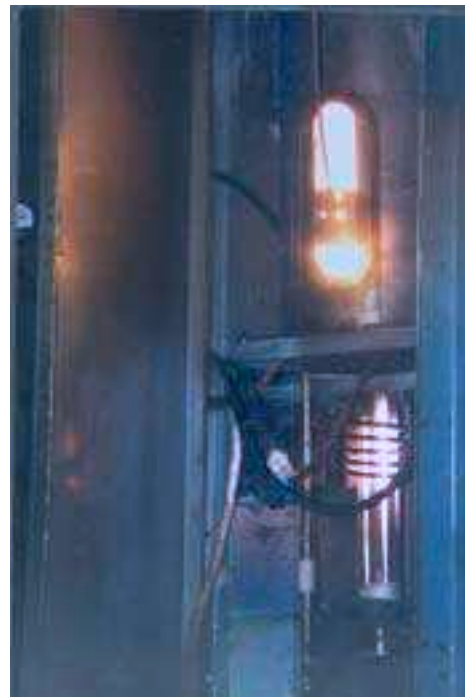
Photo 5 : Dispositif de traitement de poudre à contre courant: torche de puissance 70 kW, institut polytechnique de S t Petersburg
