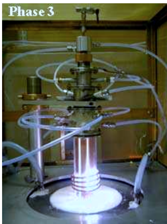
Photo 2: Le plasma thermique à P=1\text{atm} ; Phase 3: Régime permanent
