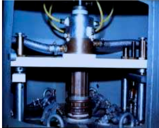
Photo 2 : L'applicateur plasma au dessus de l'enceinte de traitement
