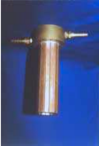
Photo 1 : L'applicateur plasma de type cage froide
