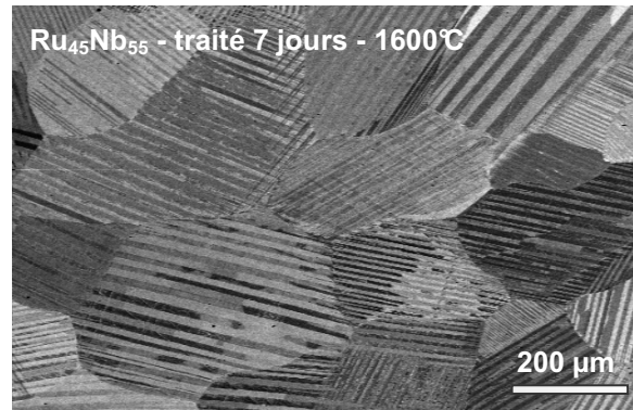
Figure 21 : Alliage Ru_{45}Nb_{55} traité 7 jours à 1600^{\circ}C - observation par microscopie électronique à balayage (électrons rétrodiffusés)
