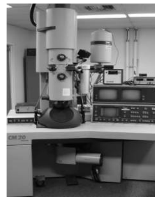
Figure 9 : Microscope en transmission Philips CM20
