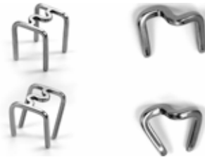
Figure 16 : Agrafe d'ostéosynthèse en position froide (haut) et chaude (bas)
