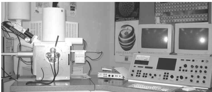
Figure 7 : Microscope électronique à balayage Zeiss DSM 962
