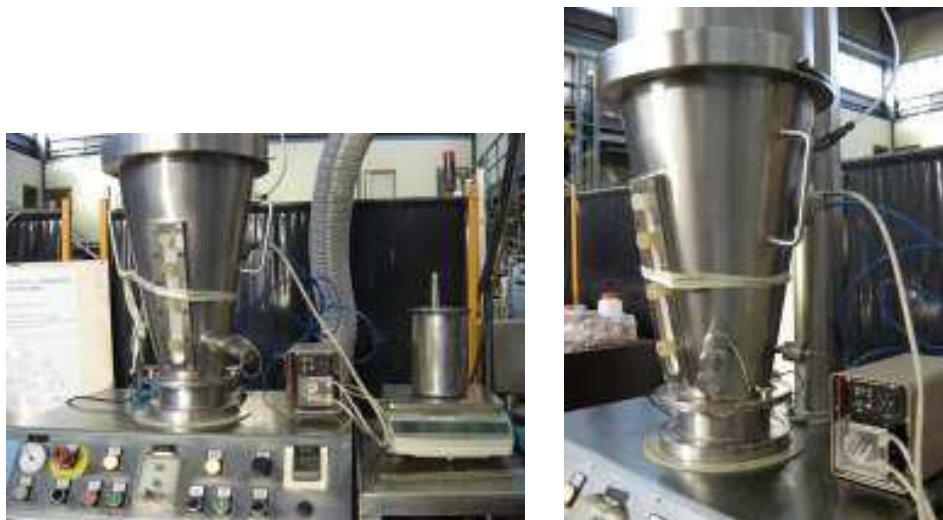
Figure 2.2.1. Pilote d'agglomération en lit fluidisé (Uni-Glatt) avec pulvérisation par le haut.
