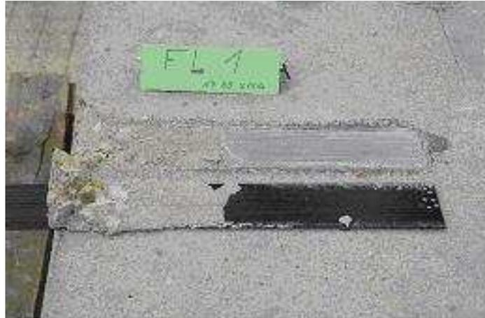
**Figure III.34 :** Faciès de rupture des corps d'épreuve après les essais de cisaillement [SUDRET 2005].
