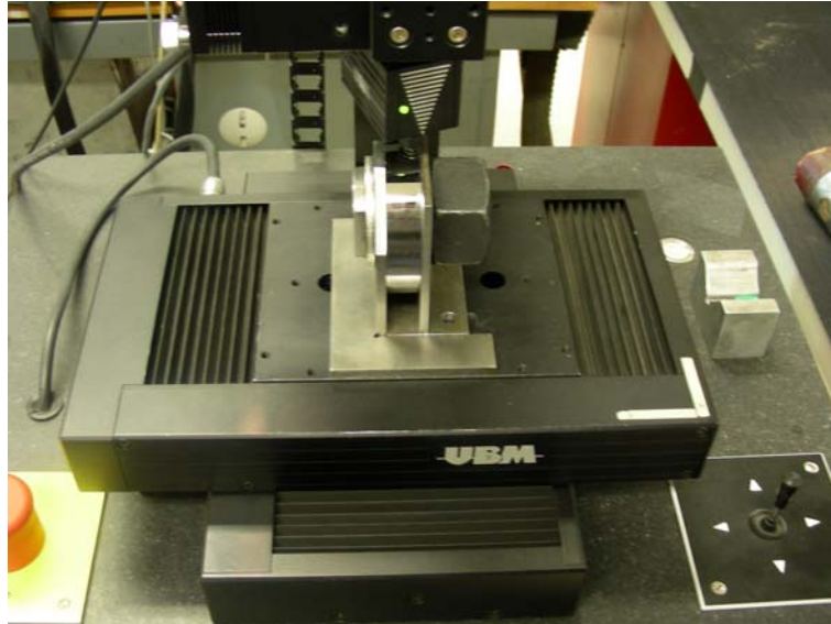
FIG. P.3 – Positionnement du galet sur le plateau du profilomètre UBM
