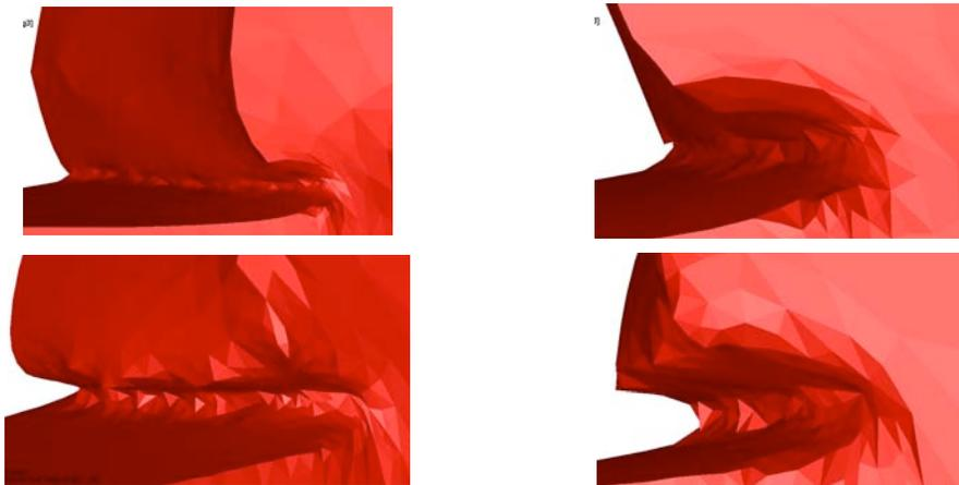
**Figure 1.88 – Vue de l’avancement du copeau et zoom sur celui-ci du côté de la surface libre pour des coupes de largeur 0,06 (première ligne) et 0,02 (seconde ligne) mm**
