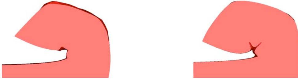
**Figure 1.37 – Copeaux obtenus sans (colonne de gauche) et avec gravite (colonne de droite)**
