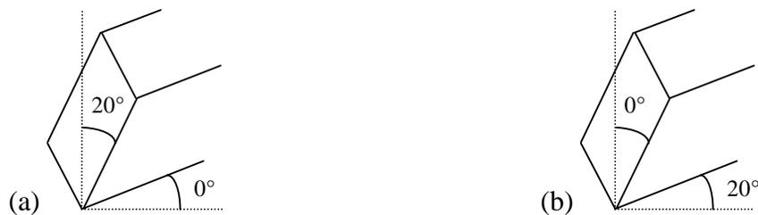
**Figure 1.47 – Etude de l'influence de l'orientation de l'outil sur la formation de BCA dans le cadre de la coupe orthogonale à grande vitesse.**
