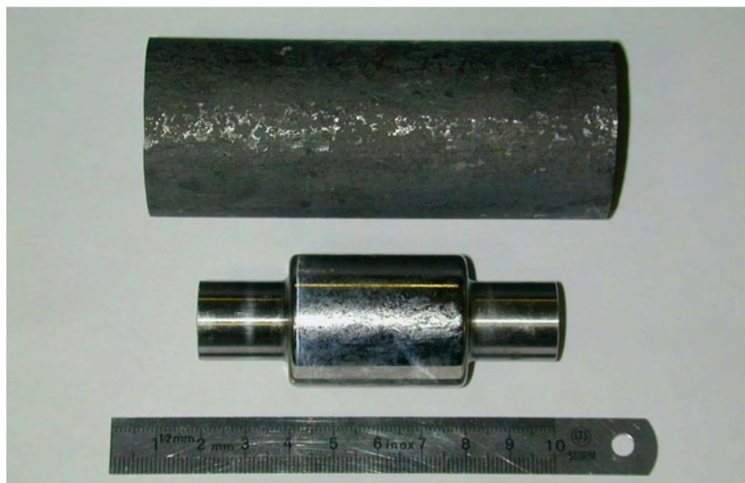
Figure 2.14 : Prélèvement et usinage des éprouvettes de fatigue thermique en X38CrMoV5.
