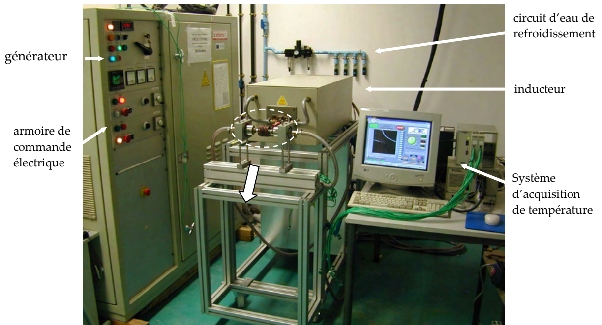
Figure 2.16 : Vue générale de l'installation de fatigue thermique
