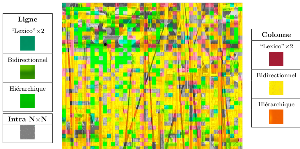
FIGURE 6.8 – Représentation spatiale de la sélection des modes Intra pour l’image 91 de la séquence Harbour 4CIF codée avec le profil Baseline III à QP 32 pour la méthode proposée.
