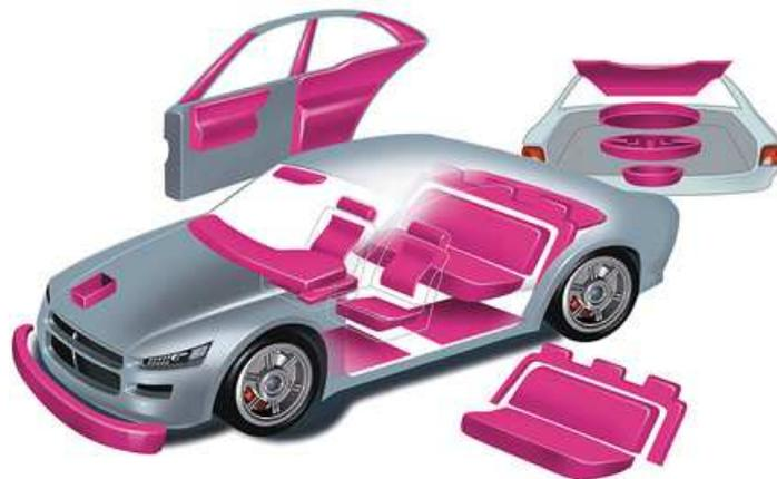
FIG. 1.2 – Exemples d'applications des matériaux cellulaires dans l'automobile : pare-chocs, assises, protections latérales, appuis-tête, etc. [Suffis, 2006]
