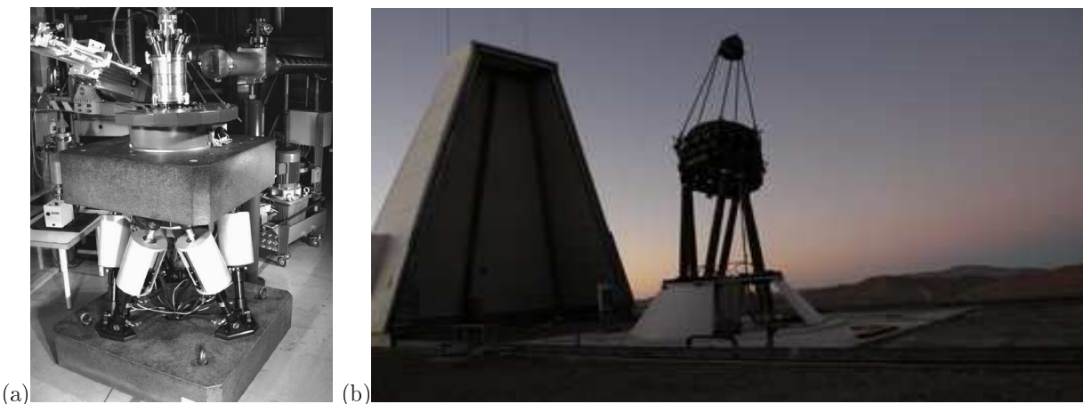
Figure 1.8: (a) Plate-forme de Gough-Stewart pour l'appui des instruments scientifiques. (b) Hexapode pour le positionnement de miroir de telescope, "La Silla", Chili.
