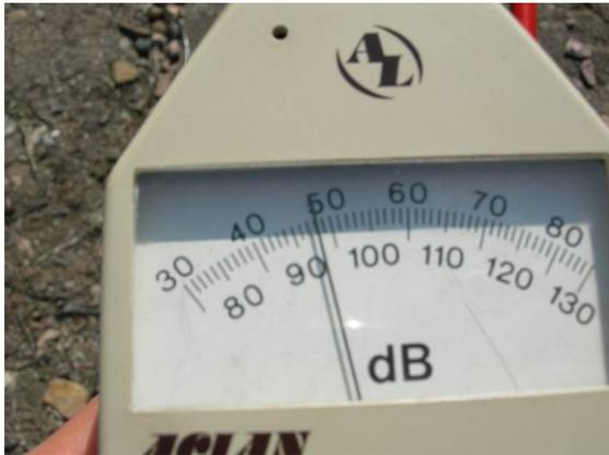
Figure 6.1.1.a. Sonomètre à aiguille
