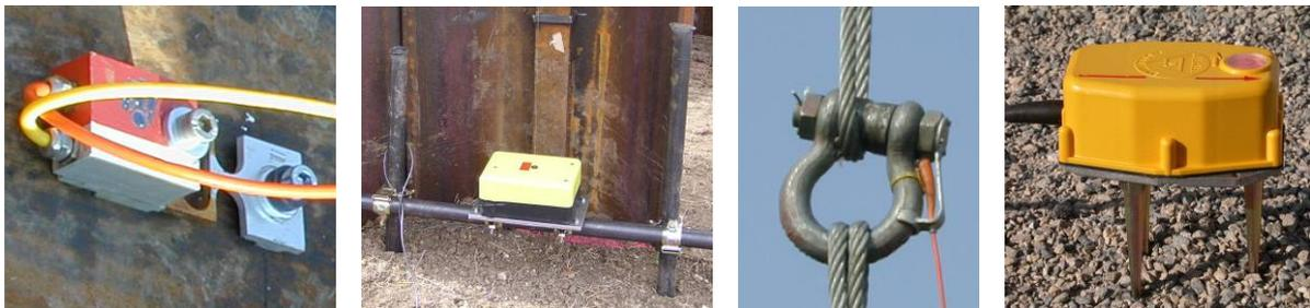
Figure 6.1.4. Accéléromètre & jauges de contrainte, capteur potentiomètre, manille, géophones 3 D
