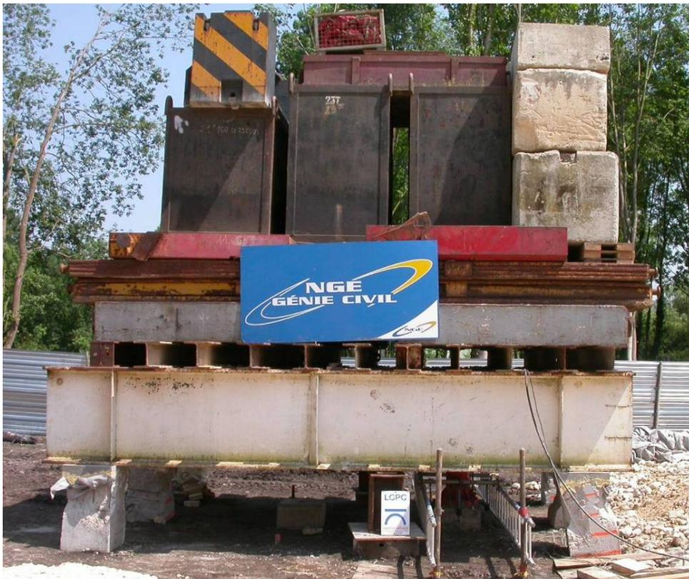
Figure 3.1. Massif poids de réaction (empilement de fonte et béton)
