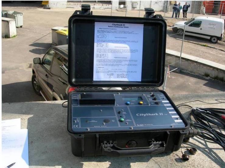
Figure 6.1.3. Boîtier d'acquisition
