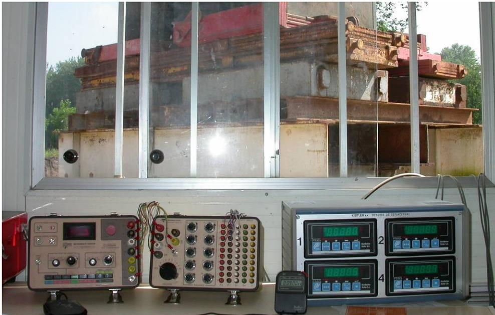
Figure 3.7. Vue du système de mesures et du massif de réaction
