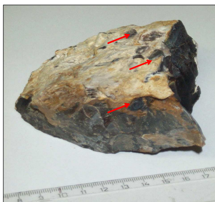
FIG. 4.15: Photographie d'un échantillon de chert de la formation de Clarno (45 Ma). Les flèches rouges indiquent la présence de tiges fossilisées
