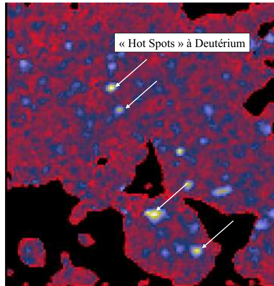
FIG. 3.12: Cartographie NanoSIMS du deutérium de la MOI de Murchison mettant en évidence les hot spots à deutérium [100].
