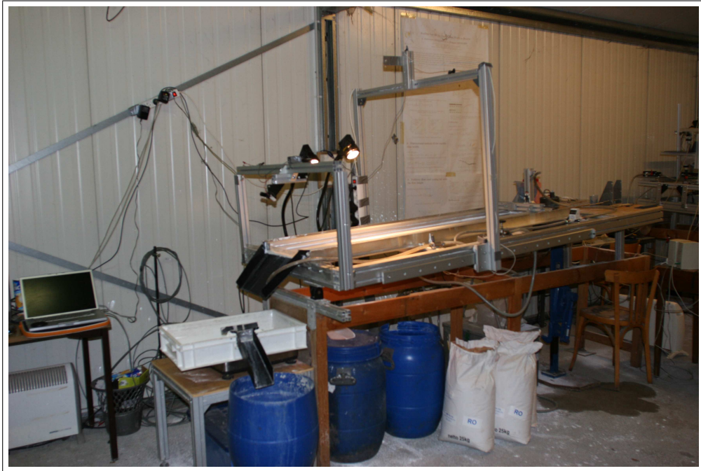
FIG. 3.1 – Photos du dispositif expérimental vu de côté en l'absence de billes de verres. À l'extrémité du plan incliné, un dévidoir est posé sur une balance, qui relie à un ordinateur. Le côté "rive droite" de l'expérience est équipé de l'électricité (on y branche les lampes, la balance, l'ordinateur ainsi que l'alimentation de l'appareil photo). L'autre côté du dispositif étant dédiée à l'arrivée d'eau, cela permet de réduire les risques liés à la présence d'eau et d'électricité. Pendant les expériences, l'appareil photo se trouve au-dessus du plan incliné de façon à prendre en photo le milieu de la micro-rivière. Les deux lasers sont fixés sur la barre Norcan qui est placée au-dessus de l'extrémité du plan incliné.
