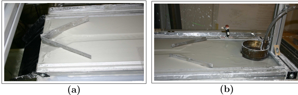
FIG. 3.3 – Photos de l'entrée (b) et de la sortie (a) de la micro-rivière. Les piscines et les plaques déviateuses placées en entrée et en sortie du dispositif préviennent la formation d'ondes parasites, qui brisent l'homogénéité des berges.
