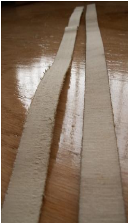
Figure 2 : rubans de placage issus de microdéroulage
