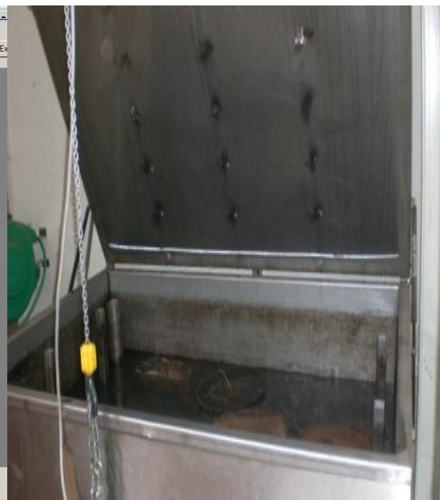
Figure II.9 - "Bouillottage" à 20°C des billons.
