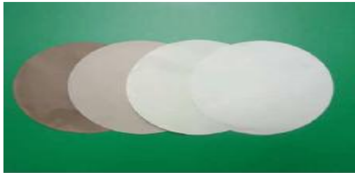
Figure I.19 - De gauche à droite : Kraft écrue de réf. / Kraft écrue peuplier / TMP peuplier-épicéa non blanchie / TMP peuplier-épicéa blanchie (FCBA).
