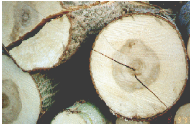
Figure I.17-Grumes de peuplier présentant des fentes d'abattage ( www.peupliersdefrance.org )
