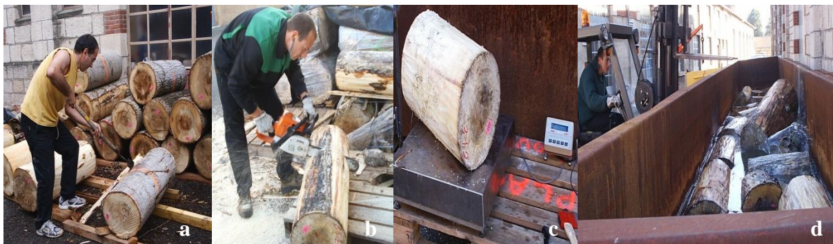
Figure II. 3- Préparation des billons. ( a : Ecorçage, b : Tronçonnage, c : Pesée, D : trempage des billons)
