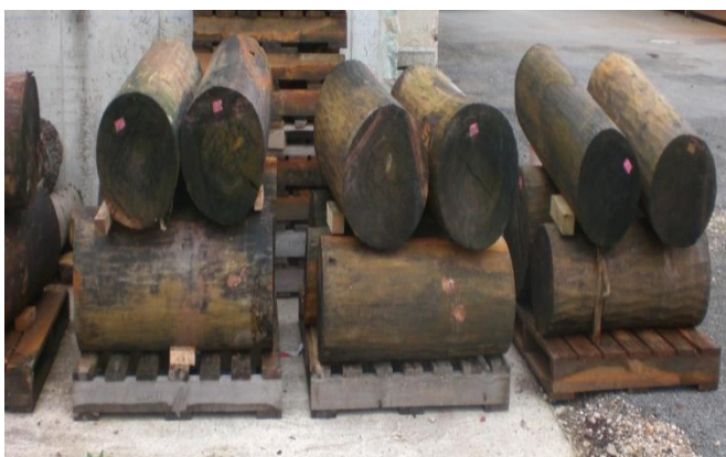
Figure II.26 - Etat des billons après un long trempage dans l'eau.
