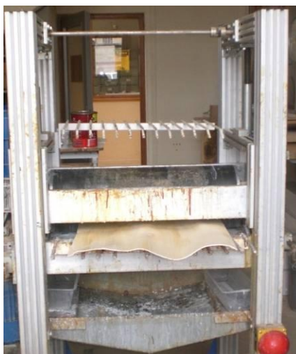
Figure II.31- Encolleuse à rouleaux.
