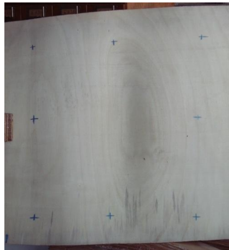
Figure II.17: Emplacement des 8 mesures effectuées pour chaque feuille de placage.
