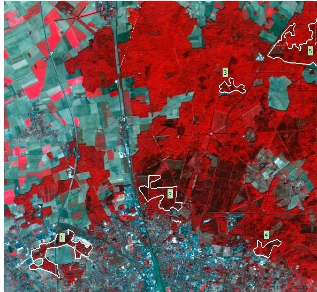
FIG. 6.7 – Image SPOT de la région du Loiret, 20m de résolution et 3 bandes spectrales : R, V et PIR. Les zones (1 à 5) détourées en blanc sont des forêts mélangées suivant la classification de CORINE Land Cover.
