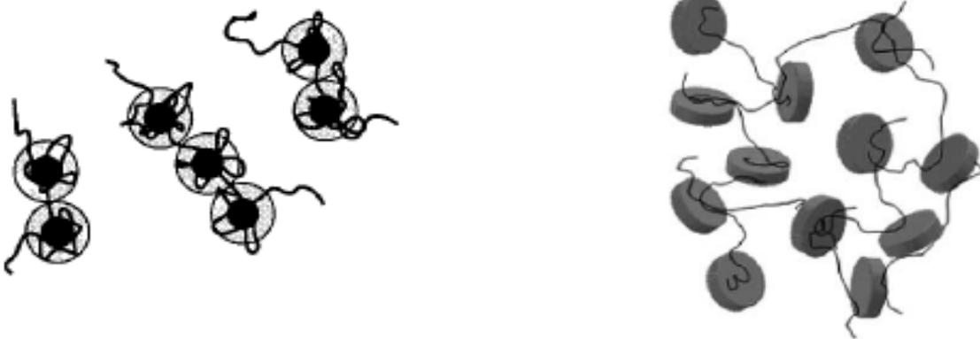
Figure 23 : Représentation schématique de particules de silice recouvertes de PEO à gauche et des particules de laponite avec du PEO à droite. Ces figures sont issues des références [10]et [11].
