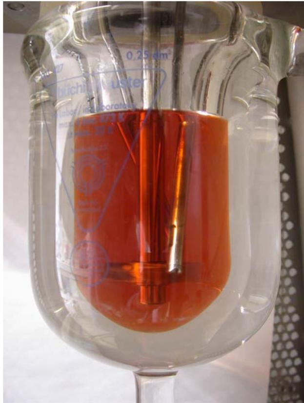
Figure 5 : Photographie du réacteur dans lequel nous avons réalisé la synthèse par ATRP des blocs latéraux du PLMA-PS-PLMA sans gradient.
