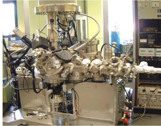
Figure AI-1 : Tribomètre Ultra Vide Analytique au LTDS à l'École Centrale de Lyon [LeM\_98]
