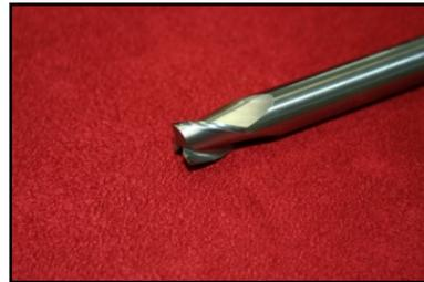
Figure AII-5 : Centre d'Usinage Grande Vitesse 3 axes DMC85V et fraise utilisée (3 dents, diamètre 10)
