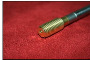
**Figure AII-7 : Centre d'Usinage Grande Vitesse 3 axes DMC65V et taraud par déformation Protodyn ECO HT TiN poli M12\*1.5**
