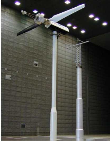
Fig.6.24 Eolienne NREL Phase VI durant l'essai dans la soufflerie de NASA à Ames Research center.
