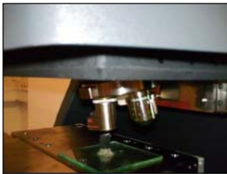
Fig. 5.8. L'éprouvette Charpy analysée au microscope interférométrique (objectif 5x)
