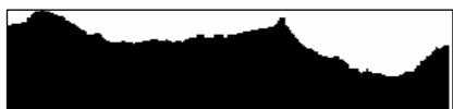
Fig.5.16. Conturul profilului obținut prin metoda Secționării Verticale pe epruveta din oțel inox 316L, (puterea de mărire la microscop: 50x)
