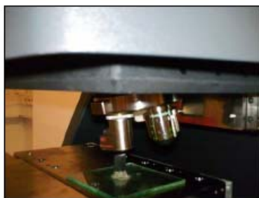
Fig.5.8. Epruveta Charpy analizată la microscopul interferometric (obiectiv 5x)
