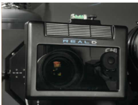
Figure 2.14 – Real D : filtre actif polarisant placé devant le projecteur
