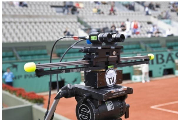
Figure 2.16 – Exemple de caméra stéréoscopique utilisée sur le tournoi de Roland Garros
