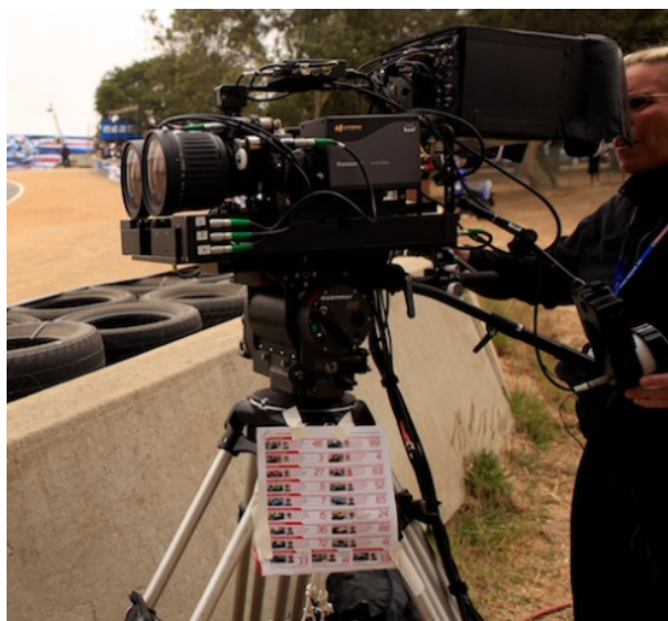
Figure 1.6 – Caméra stéréoscopique de nouvelle génération pour le cinéma : le système Pace Fusion 3D lors d'un tournage sur un Grand Prix de moto aux USA en Juillet 2009.
