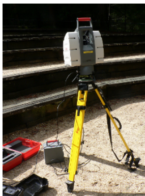
Figure 2.2 – Exemple de scanner par temps de vol : le Leica HDS-3000
