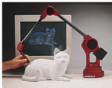
Figure 2.1 – Exemple de bras mécanique servant à l'acquisition par contact
