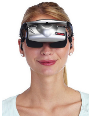
Figure 2.12 – Exemple de casque de Réalité Virtuelle : l'eMagin Z800 de 3Dvisor. On distingue les deux écrans, un devant chaque oeil.
