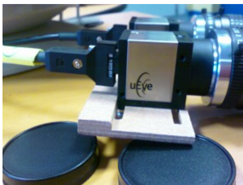
Figure 6.1 – Banc stéréoscopique uEye : le support bloquant la rotation des caméras
