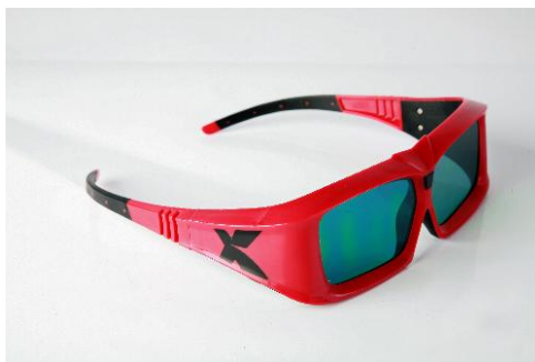
Figure 2.13 – XpanD : paire de lunettes stéréoscopiques actives. Au centre, au niveau du nez se trouve le récepteur infrarouge pour la synchronisation des lunettes avec la projection
