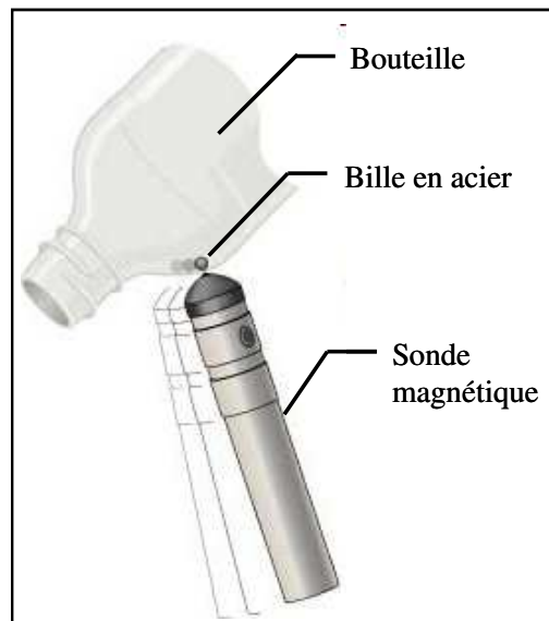
Fig. 3.40 - Principe de la mesure d'épaisseur
