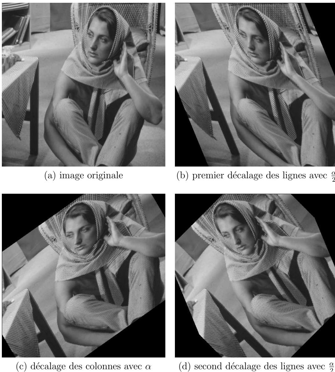
FIG. 4.36: Exemple de rotation d'angle \alpha = \frac{\pi}{8} d'une image par décalage
