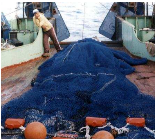
Photo (2) du chalut avant le filage avec les capteurs SCANMAR accrochés au chalut
