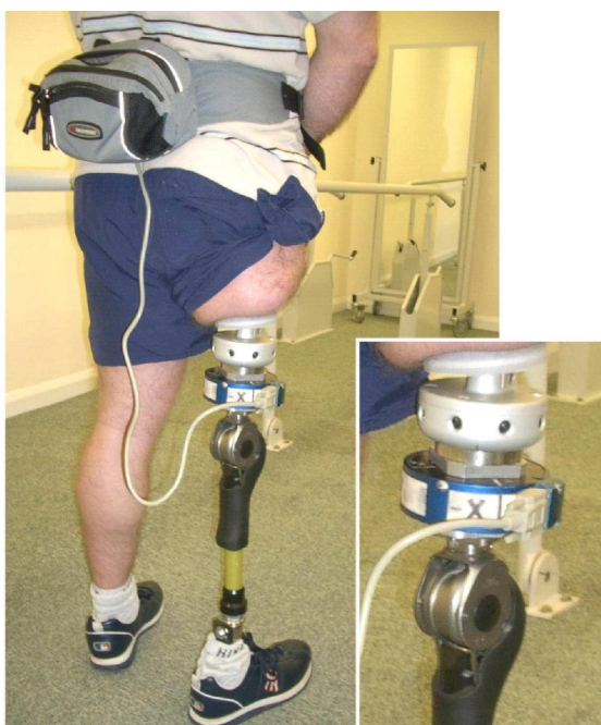
Figure 39 : Mesure directe au dessus du genou prothétique (Hicks, Tashman et al. 1985).
