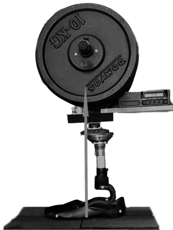
Figure 67 : Positionnement des mires pour le suivi 2D
