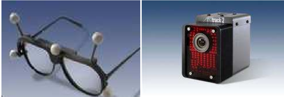
Figure 20 : système pour suivre la position et l'orientation du sujet (ART-tracking)
