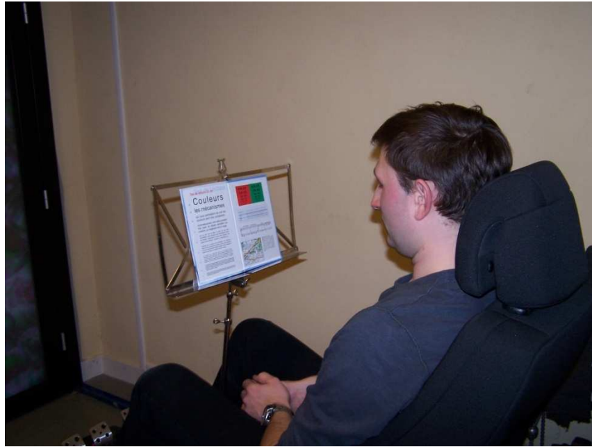
Figure 169 : la mire est fixée à 40 cm des yeux du sujet grâce à un pupitre fixé au siège
