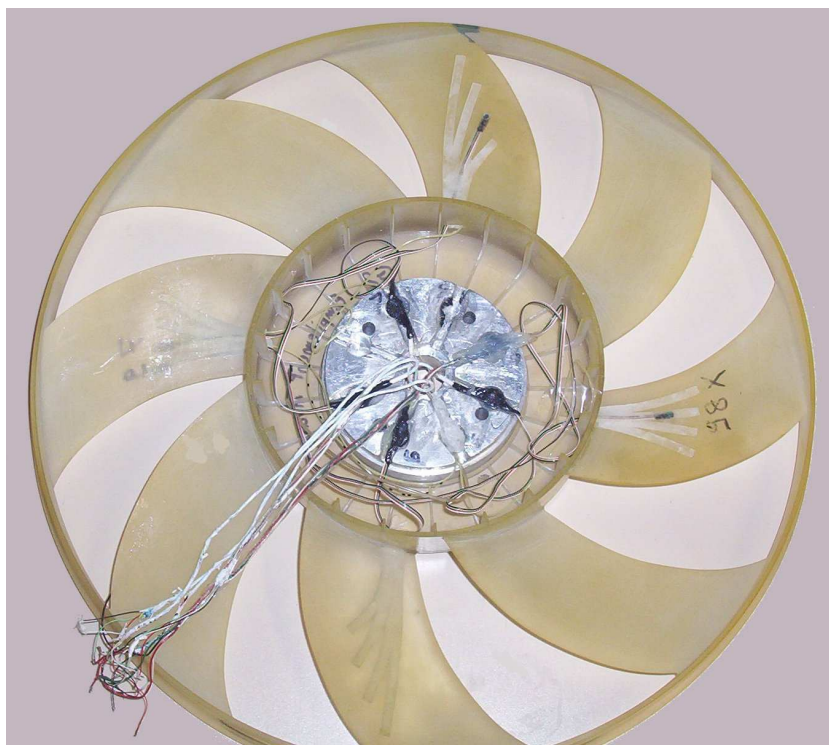
FIGURE 3.13 – Vue arrière du ventilateur G2for instrumenté par 4 capteurs, avec les amplificateurs positionnés dans le bol spécifique
