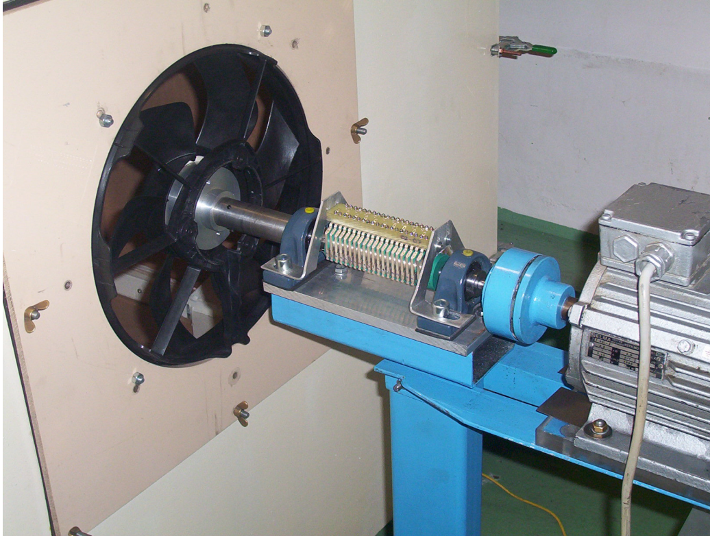
FIGURE 3.12 – Photographie du banc d'essai avec le ventilateur installé dans le caisson normalisé
