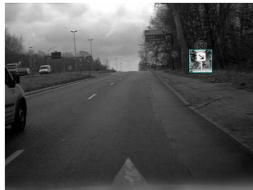
Figure 63 – Egalisation d'histogramme de la zone de recherche
