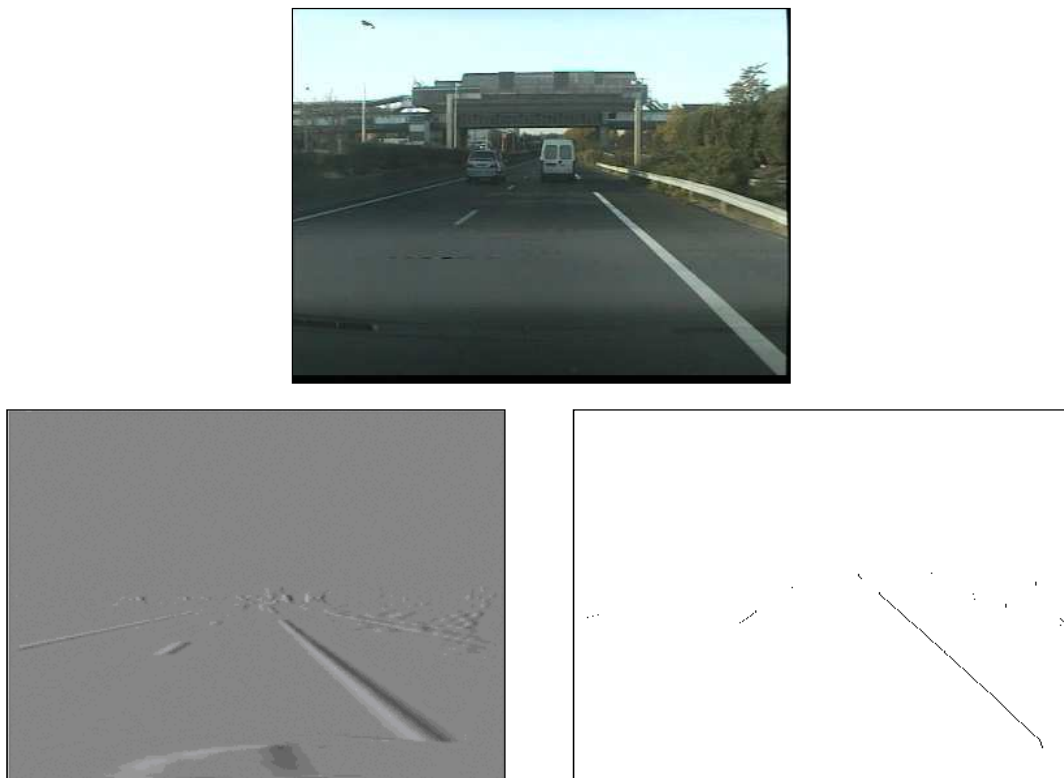
Figure 145 - Exemple de détection des centres de marquage
