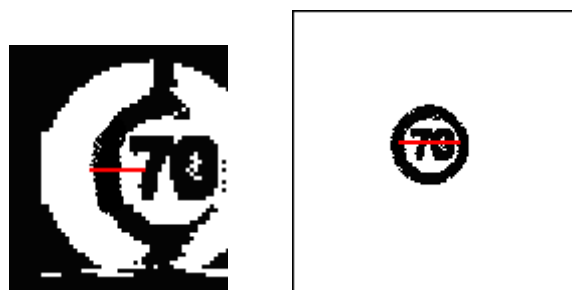
Figure 32 - Deux cas où la segmentation holistique ne fonctionne pas
