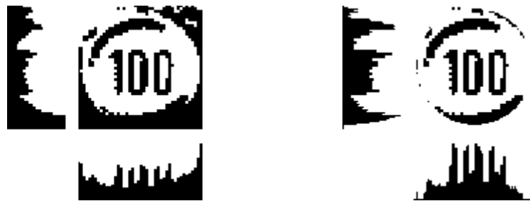
Figure 16 - Impossibilité de compter le nombre de pics verticaux dans l'histogramme pour segmenter les chiffres (panneau allemand)
