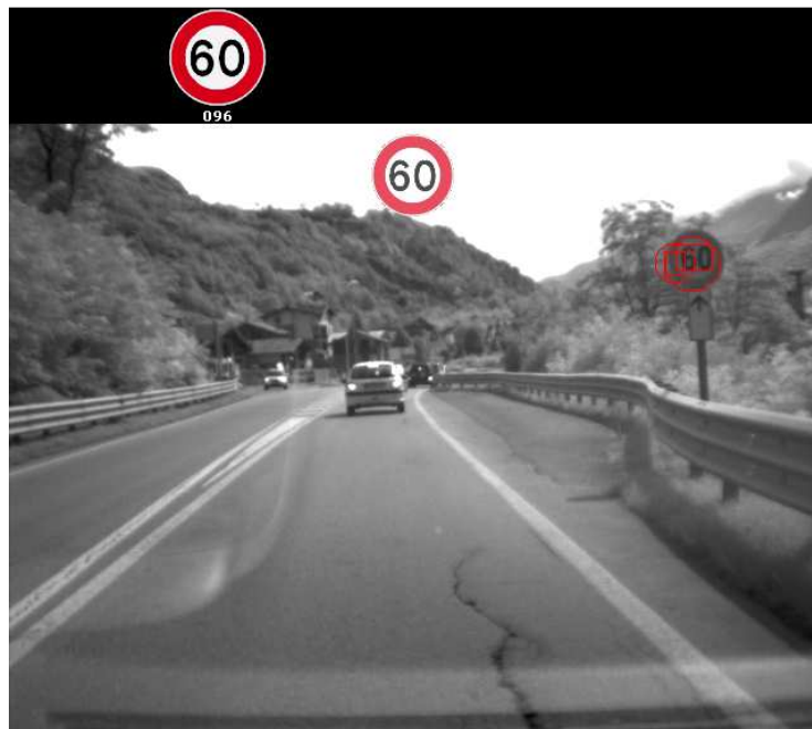
Figure 95 - Reconnaissance d'un panneau de limitation de vitesse italien, illustrant des résultats prometteur pour un système européen global
