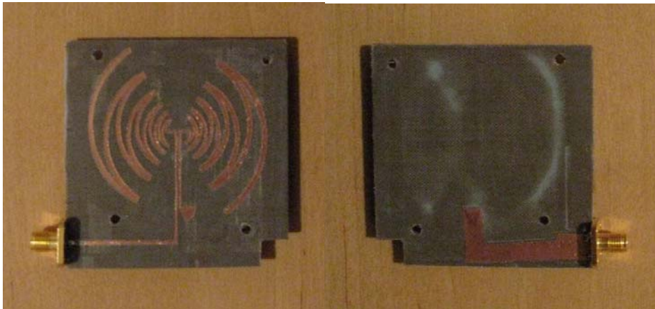
Fig.21. Photos de la configuration fabriquée de l'antenne sinueuse simple polarisation.
