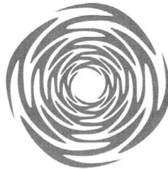
Fig.2. Géométrie de l'antenne sinueuse.
