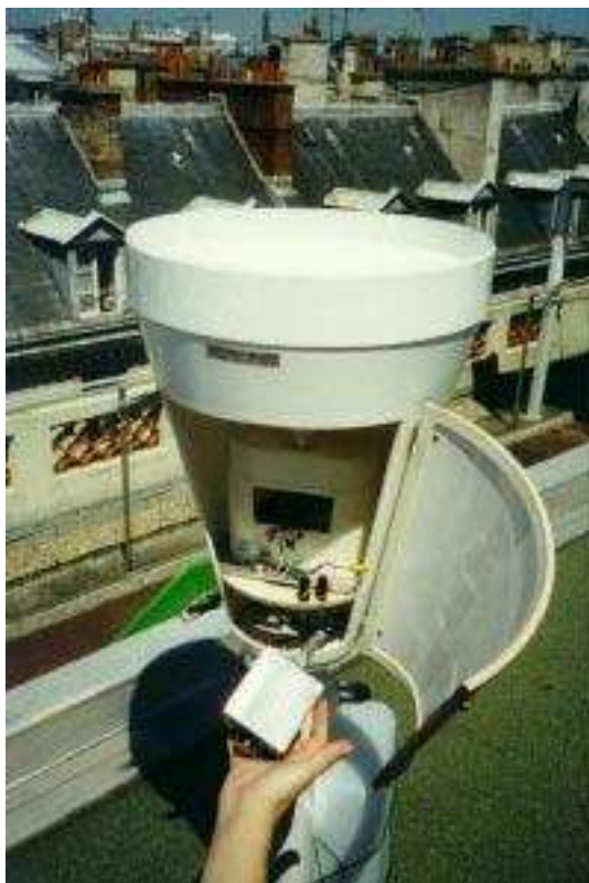
Figure I.5 : Pluviomètre à augets basculeurs disposé sur le toit de la crèche à côté de l'ARS 1000
