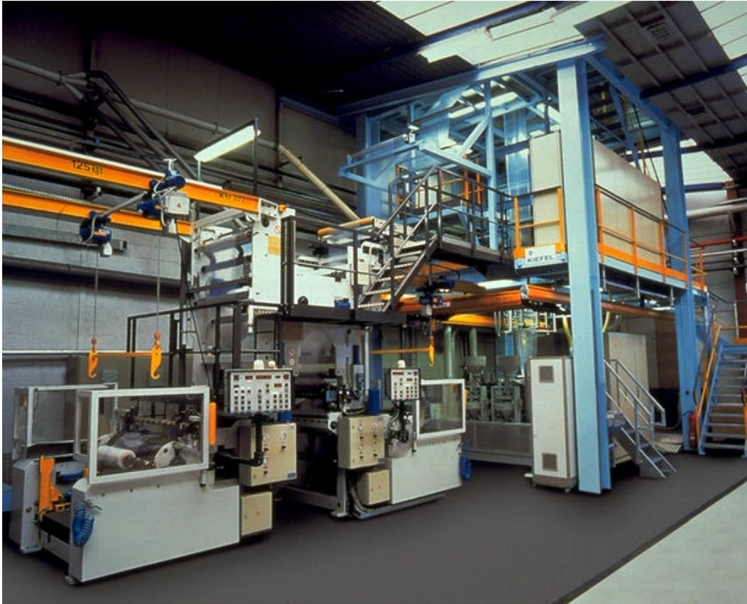
figure 1.3 : Vue générale d'une ligne de soufflage de gaine industrielle KIEFEL (source ATOFINA)
