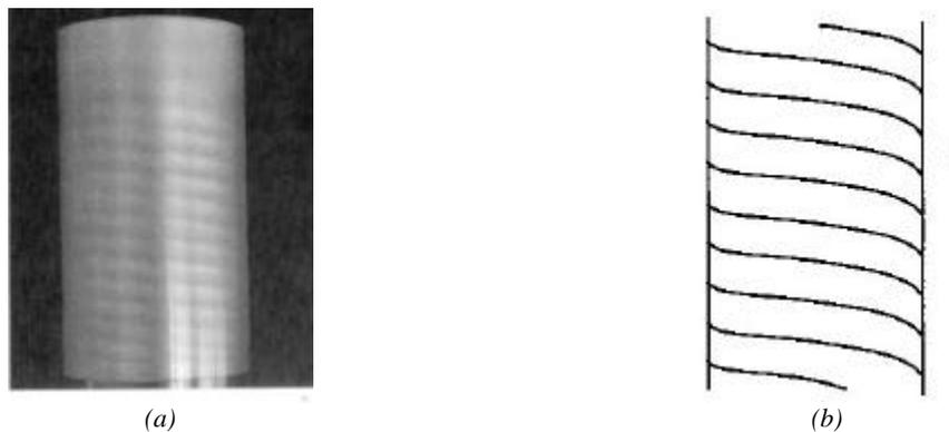
figure 5.3 : Ecoulement en spirales (d'après [CHO,94]) ; (a) : photographie ; (b) : schéma de l'écoulement
