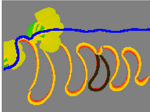
FIG. 5.19 – Avulsion réussie et nouveau cours du chenal sur la plaine d'inondation La plaine d'inondation, représentée en vue aérienne, mesure 6 km de long pour 3 km de large. On peut observer en kaki, un bouchon d'argile résultant d'un recoupement par tangence plus ancien.
