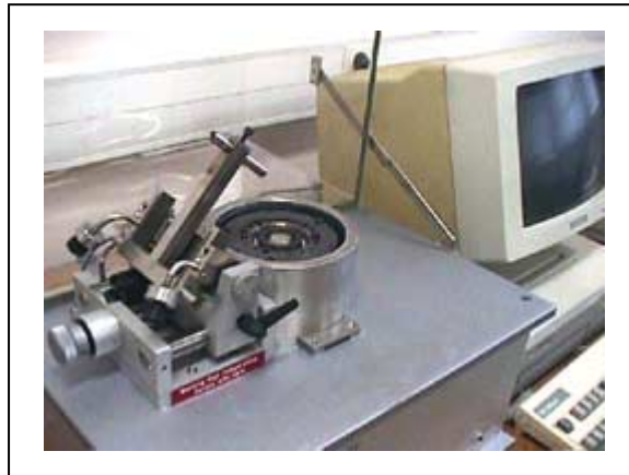
Figure 1 : Vue d'ensemble du tribomètre haute température de configuration bille-sur-disque à rotation continue.
