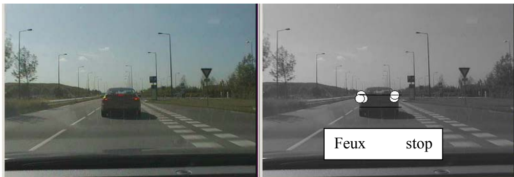
Figure 82 : détection de feux stop
