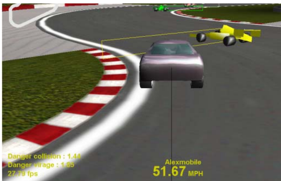
Figure 50 : suivi de véhicule présentant un fort risque de collision : temps de réaction autorisé = 1.46s
