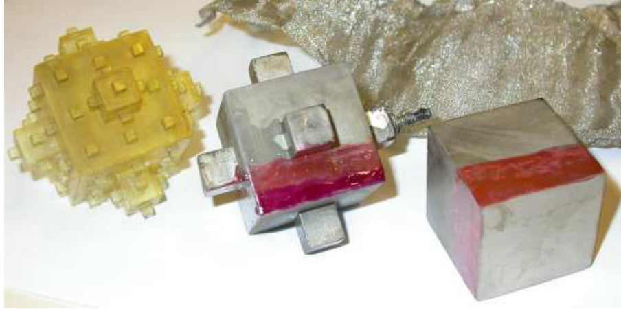
FIG. 7.4 – Photo d'une carcasse en résine époxy pour la deuxième génération (à gauche) et de deux électrodes métallisées (au centre et à droite) représentant la première génération et la surface plate ; le tissu du platine est utilisée comme la contre-électrode (en arrière). Une partie de la surface des électrodes métallisées est couverte par un vernis isolant (en rouge).
