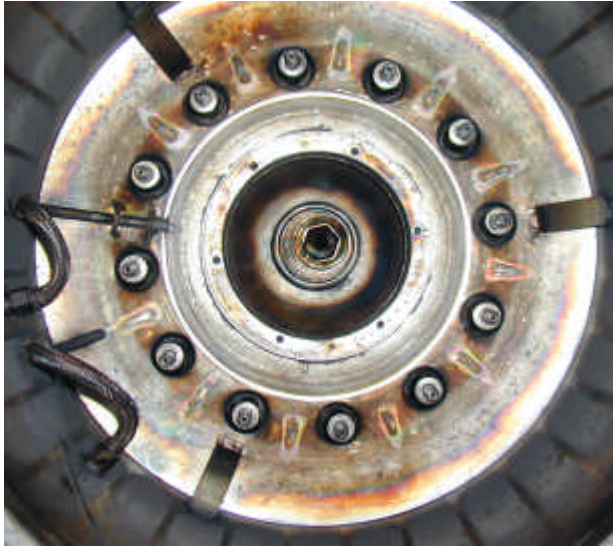
Figure V-9 : traces de fuites dans la convolute
