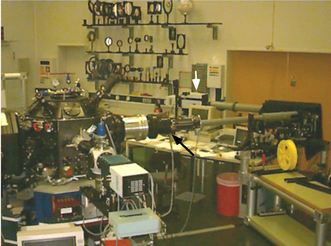
*Fig.4.2: Photographie de la chambre d'interaction du MPQ. On voit (indiqué avec la flèche noire) l'extrémité extérieure du tube introduit à chaque tir dans l'enceinte avec l'objectif de reprise d'image. La flèche blanche indique la caméra streak.*
