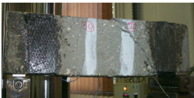
Figure III-35 Rupture due à l'effort tranchant de la poutre renforcée en mode c sous chargement monotone (poutre n°10, HA10)
