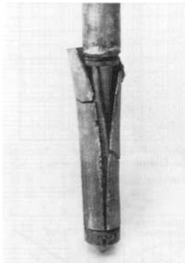
FIG. 1.14 – Etat d'un piézomètre après mise en place par vibrofonçage dans une grave argileuse (Gosset & Khizardjian, 1976) .
