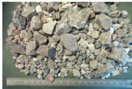
FIG. 4.7 – Vue des graviers 4/20 mm
