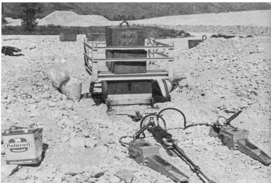
FIG. 1.9 – Vue du dispositif de cisaillement direct par traction (Laréal et al., 1973) .
