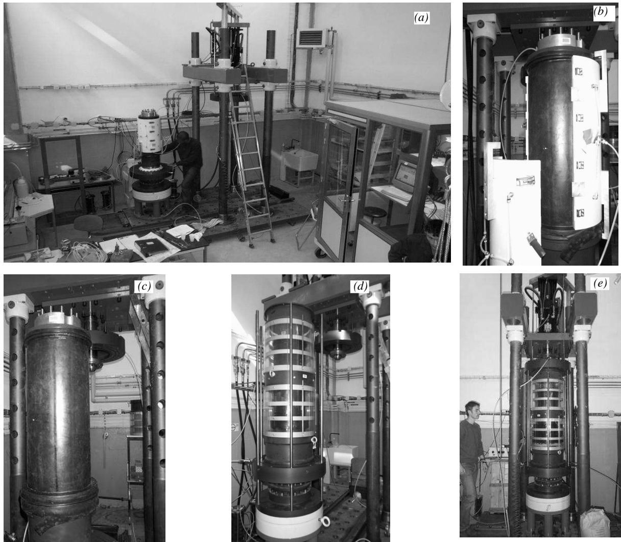
FIG. 2.18 – Illustration de la procédure de réalisation d'un essai sur le dispositif triaxial de grande taille.
