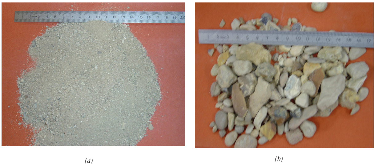
FIG. 5.21 – Vue de la fraction 0/4 mm : matrice et de la fraction 4/20 mm : inclusions
