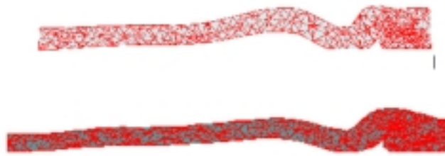
FIG. 4.12 – Coupe montrant la formation de replis de matière dans le SIMULACRO
