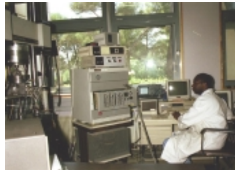
FIG. 3.3 – (a) Montage expérimental et son instrumentation, installés sur une machine de traction-compression et (b) dispositif d'acquisition des résultats
