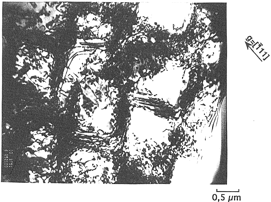
Figure II.18 : Micrographie (MET) d'une lame [111] montrant le glissement majoritaire des dislocations dans un plan (001) pour l'éprouvette X1108B d'orientation [111] à 650°C.
