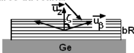
FIG. 4.6 : Echantillons orientés de membrane pourpre. Les dipôles sont orientés suivant l'axe \vec{u}_\beta dans un cône de demi-angle au sommet \zeta \approx 71^\circ par rapport à l'axe \vec{u}_z [18].
