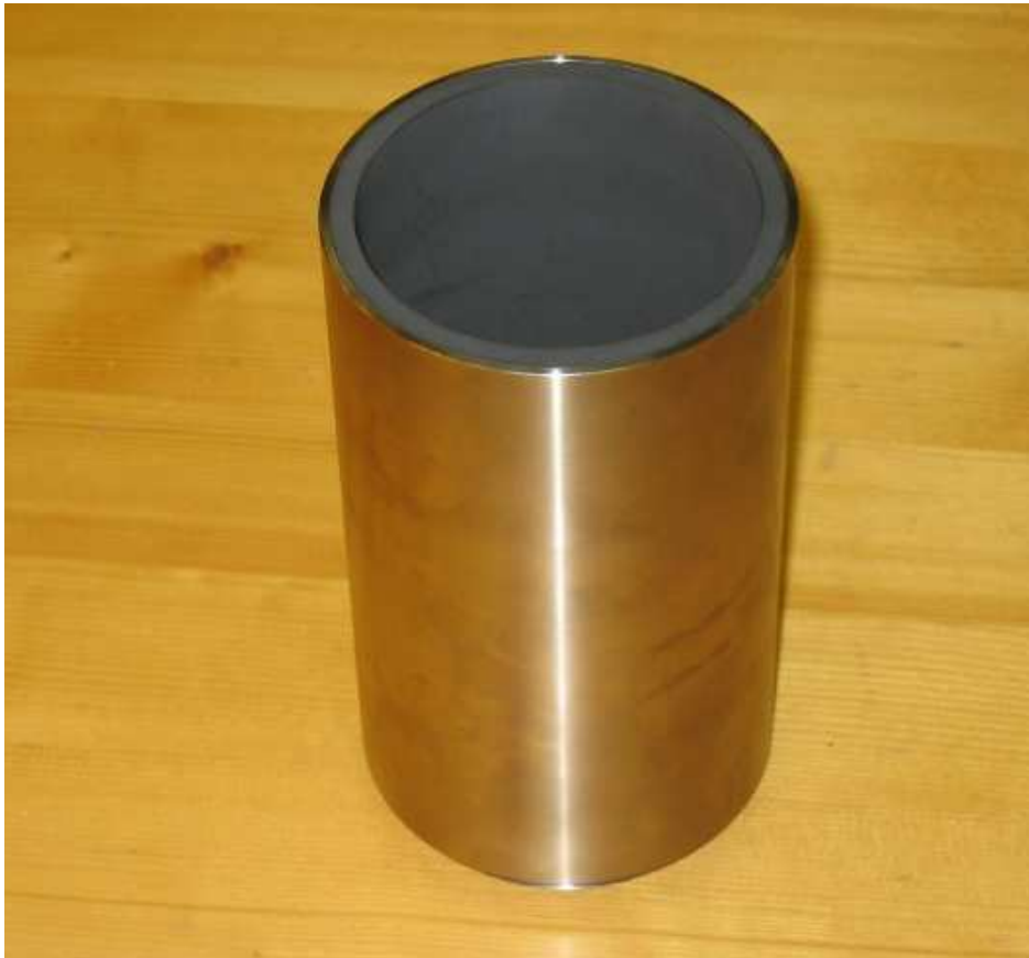
Figure V-6 : Vue de détail du collecteur avec sa chemise d'inox et la coupelle de graphite sertie (épaisseur 5mm) qui recouvre tout l'intérieur. Cliché LPTP 2004
