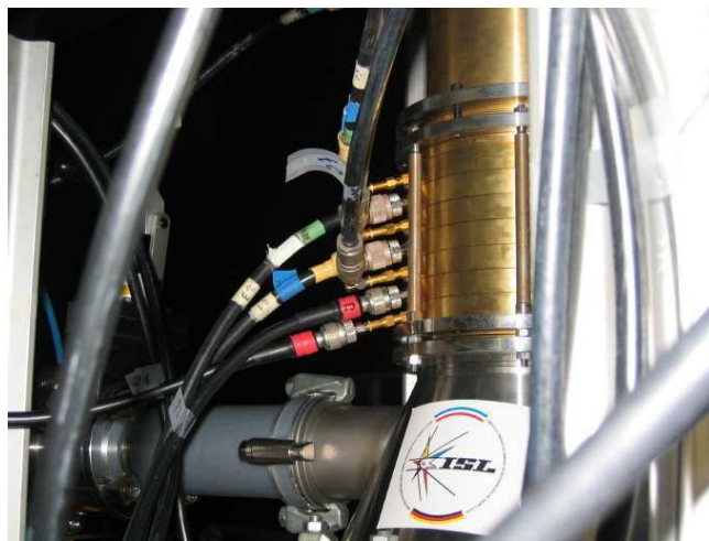
Figure V-17 : Vue des sorties de mesure de courant au niveau de la structure à ondes lentes B, C, D, E, F, G, H de haut en bas. Cliché LPTP 2004
