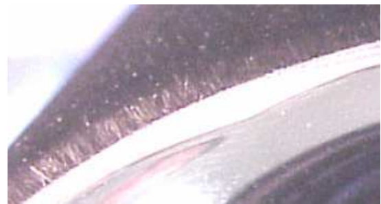
Figure II-3b: Velours de carbone du MILO US Air – Force : 1,5 mm d'épaisseur avec une densité de mise en paquet des brins de 0,4%. On distingue les fibres de carbone, montées sur une couche d'époxy et posées sur la surface en aluminium de la cathode [KNOWLES, 01].
