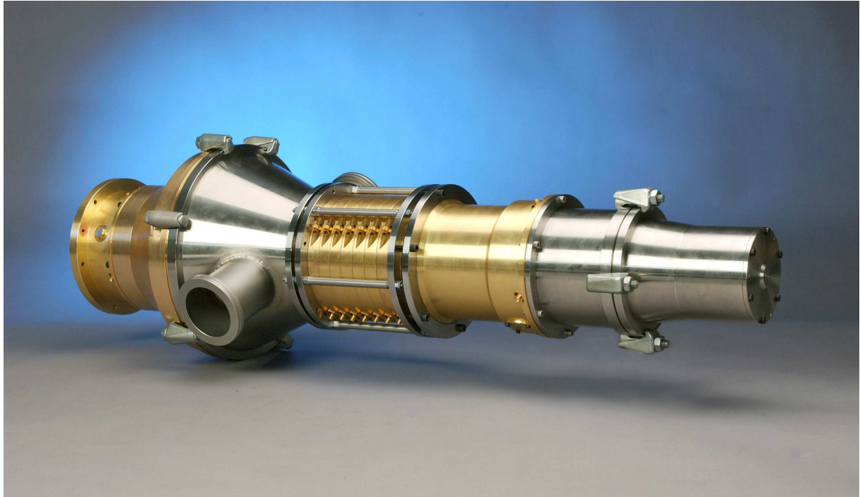
Figure V-2 : Photographie du MILO compact monté et muni de sa résistance terminale, à l'intérieur du boîtier en inox à l'extrémité droite. © Cliché ISL 2004.
