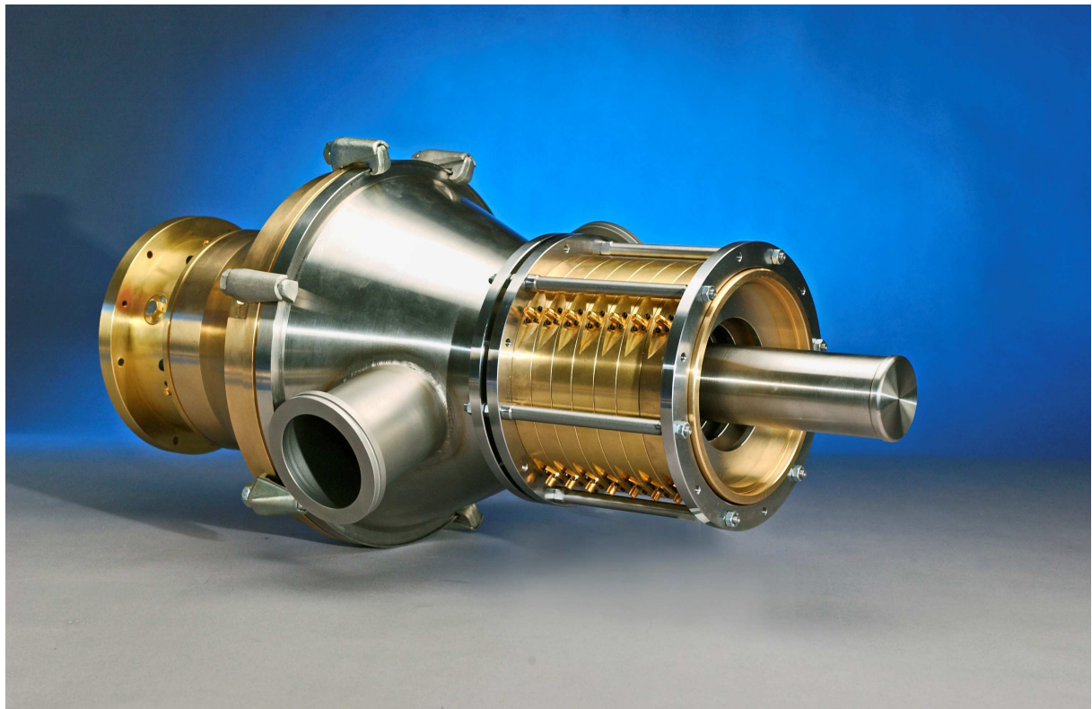
Figure V-3 : Photographie du MILO compact monté, ouvert au niveau de l'extracteur. On voit sur l'axe la cathode de diamètre 50 mm, dépourvue de son velours, et autour les iris : au premier plan l'iris d'extraction, plus ouvert, ensuite le premier iris de cavité. On distingue également les couronnes, munies chacune de 4 prises SMA pour la mesure du courant, dont l'empilement alterné avec les disques réalise la structure à ondes lentes. Cet empilement, retenu par 6 tirants entre deux brides inox, forme un bloc indépendant centré en atelier avec une tolérance de 0,2 mm. © Cliché ISL 2004.
