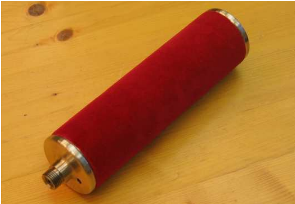
Figure V-5 : Partie terminale de la cathode (diamètre 5 cm) en acier inox recouvert de velours de polyester sur l'essentiel de sa longueur. On note le raccord fileté vers la canne de liaison au générateur. Les propriétés émissives du velours ont été décrites au § II-I du chapitre II. Cliché LPTP 2004
