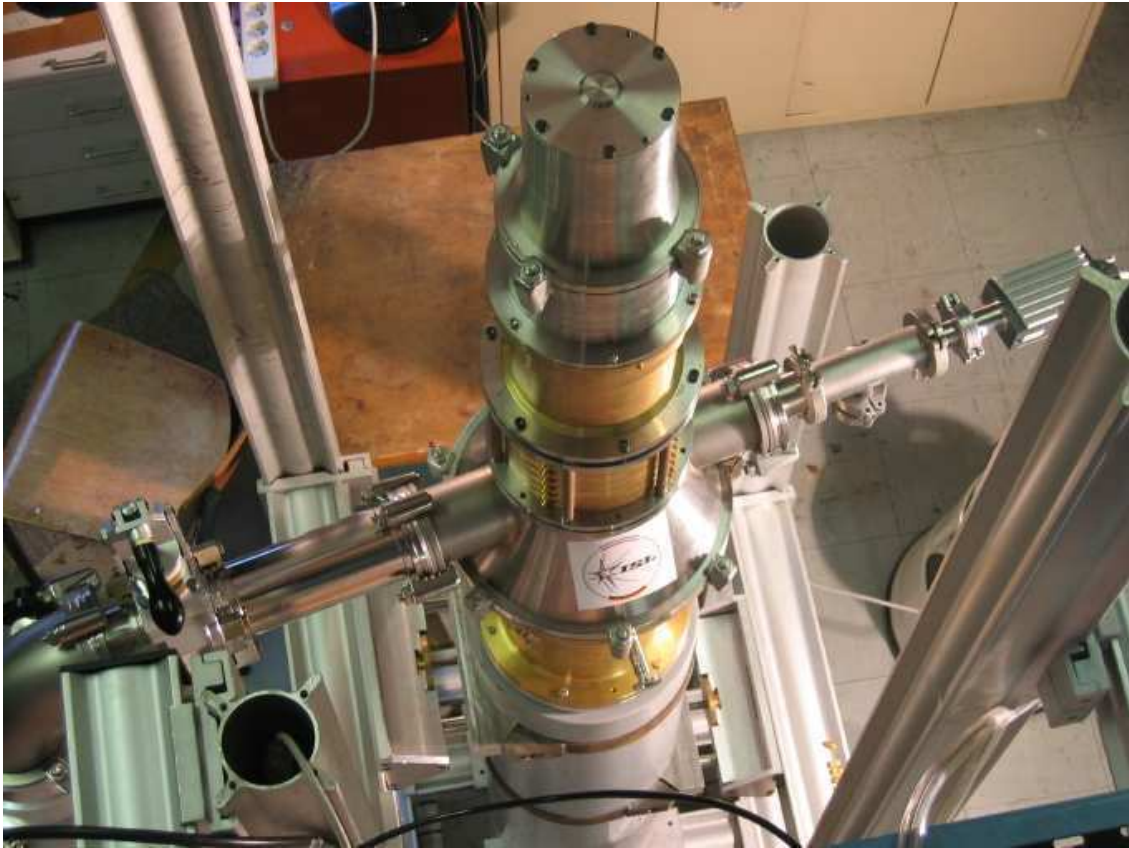
Figure V-13 : Vue de dessus du MILO monté avec son système de pompage et de mesure de vide. Cliché LPTP 2004
