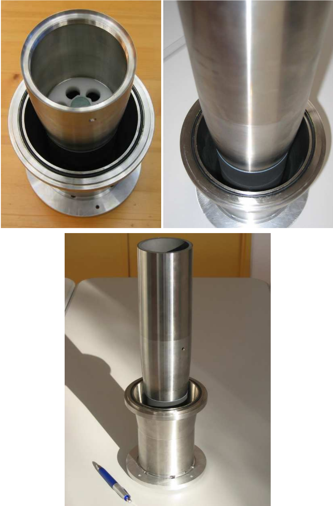
Figure V-7 : Ensemble résistance porte-collecteur. En haut à gauche on distingue l'empilement des anneaux de céramique conductrice (HVR Ltd) et le système de pressage (isolant perforé) du joint élastomère conducteur (bleu). Sur les autres vues, le collecteur a été vissé et on note les transitions de matériau ainsi que l'évolution du diamètre (profil exponentiel). Clichés LPTP 2004
