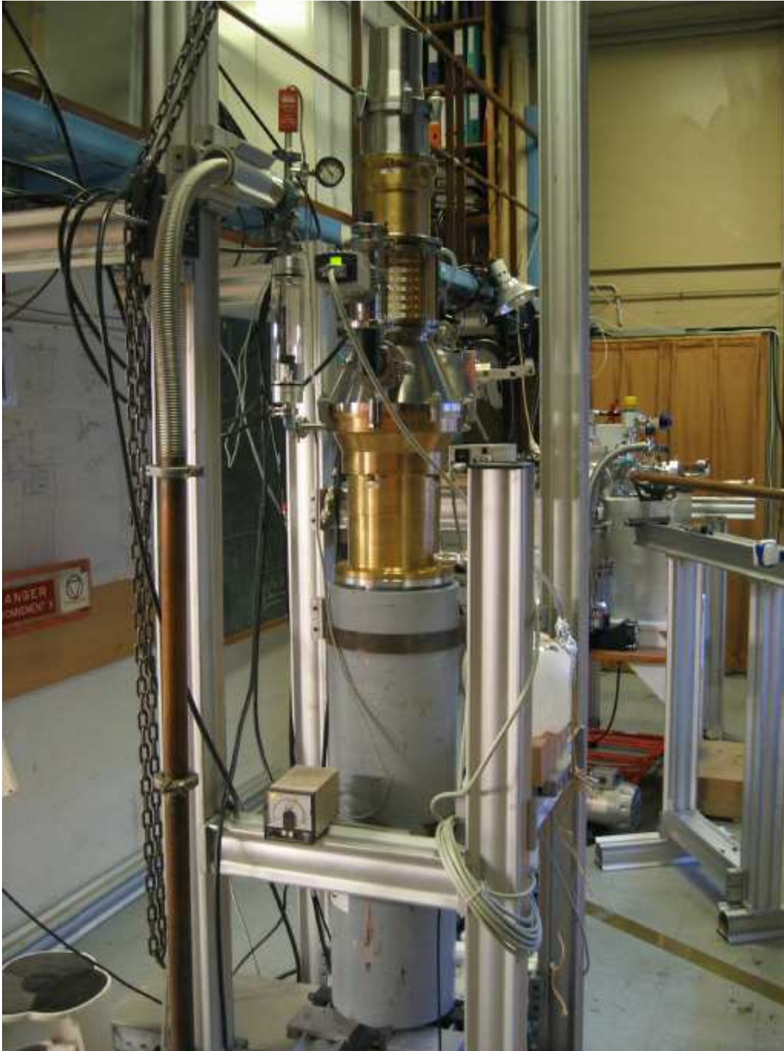
Figure V-12. Vue d'ensemble du tube MILO, dressé sur le Marx compact ISL (cylindre gris). La hauteur au sol est de 2,8m. A gauche on voit le circuit de pompage et le volume d'expansion pour le dégazage du galden ® contenu dans la virole de laiton au centre. Un jerrican blanc contient la réserve de galden. La pompe turbomoléculaire est cachée derrière la transition conique en inox ainsi que le groupe de pompage primaire derrière le Marx. Les câbles coaxiaux mènent à la cage de Faraday située à 4m. Cliché LPTP 2004.
