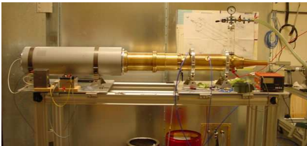
Figure V-9 : Vue du Marx ISL en position horizontale pour les tests de décharge sur une ligne coaxiale Z= 50 \Omega sous galden. La ligne est terminée par une résistance tubulaire coaxiale [WEY, 02] précédée d'une lentille TEM en laiton. La tension est mesurée sur la résistance via un diviseur de tension de 39,2dB et par une sonde capacitive D-dot visible en milieu de ligne. ©Cliché ISL 2004
