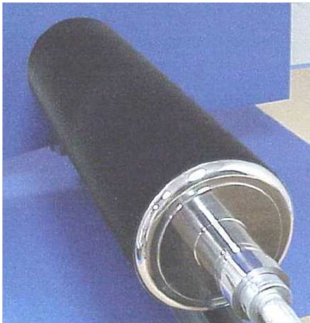
Figure II-3a: Cathode cylindrique en velours de carbone utilisée pour le MILO de l'US Air – Force (longueur 50 cm ; rayon ~ 5 cm) [KNOWLES, 01].
