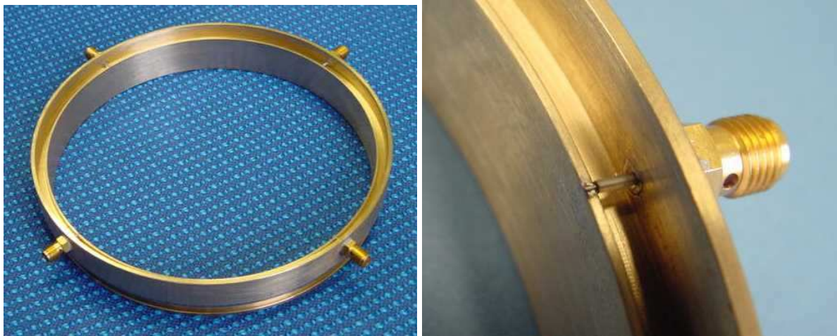
Figure V-15 : Photographies d'une bride de laiton équipée d'une gorge inductive \varnothing 139 \times 145 mm à 4 prises SMA [LAROUR, 03]. L'inductance rajoutée est de 17pH, générant un signal typique de 17V pour un courant croissant à 1kA/ns. © Clichés ISL 2003
