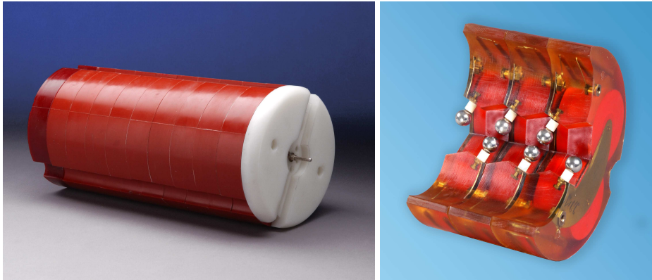
Figure V-8 : Photographie de détail de l'intérieur d'un Marx ISL montrant l'empilement des galettes et une vue éclatée de trois galettes. On reconnaît pour chaque galette, deux condensateurs rapides en rouge vif, les boules de l'éclateur à air pressurisé (environ 2,5 bars) et les connecteurs de laiton. © Clichés ISL 2004
