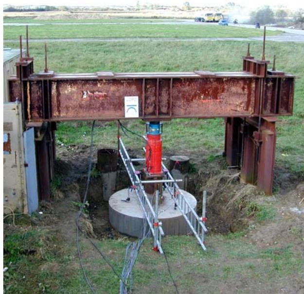
**Figure 5.27 – Vue d'ensemble de l'essai de chargement sur la fondation mixte à Merville**
