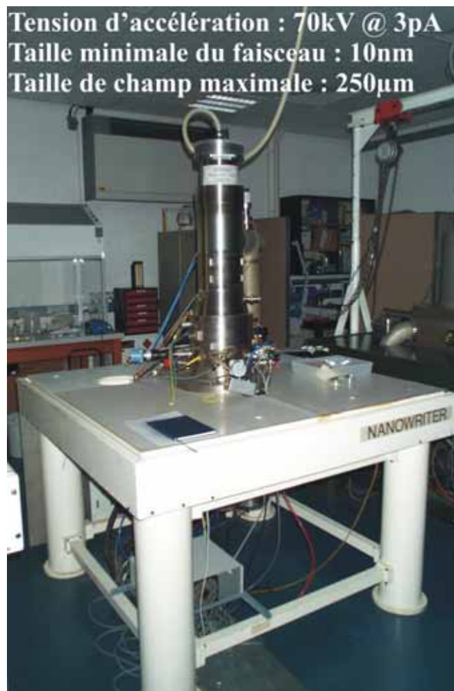
Figure 2-34: Masqueur Q-beam de l'Université de Cambridge.
