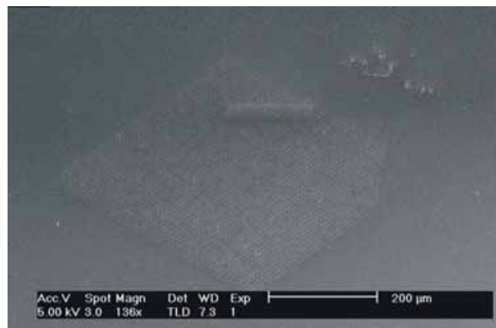
Figure 2-57: Croissance de nanotubes de carbone par PECVD sur des plots de Ni/TiN de diamètre 100nm définis par nano-impression.
