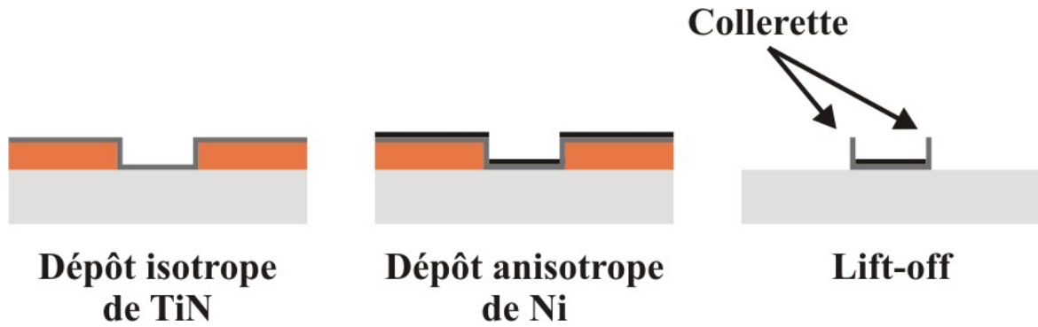
Figure 2-30: Formation de la collerette lors du lift-off.
