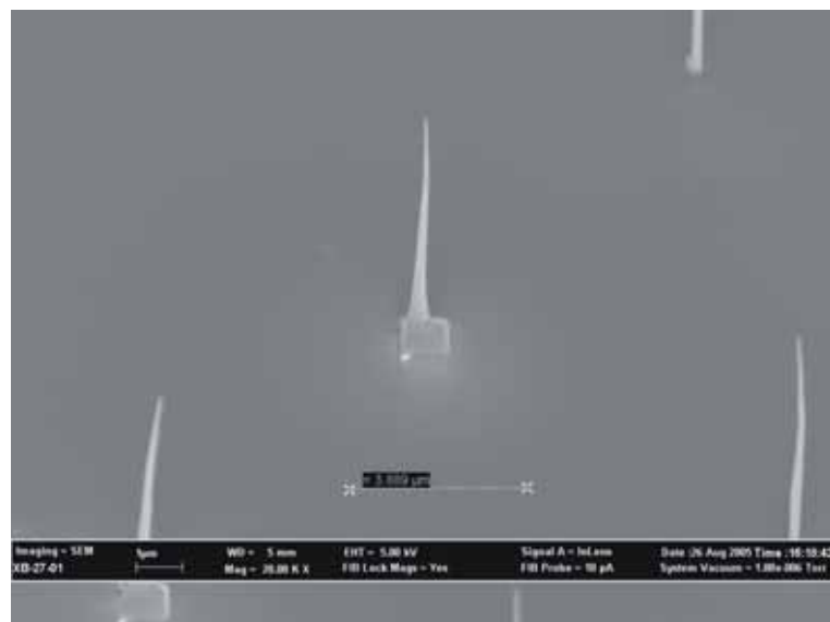
Figure 2-67: Dépôt localisé de Pt au pied des nanotubes de carbone. On ne dépose pas de Pt sur le corps du nanotube.
