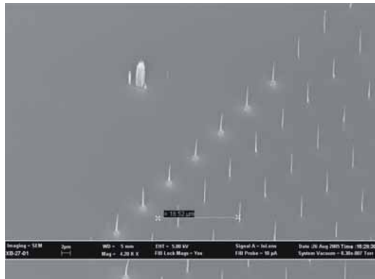
Figure 2-66: Dépôt localisé de Pt au pied des nanotubes de carbone.
