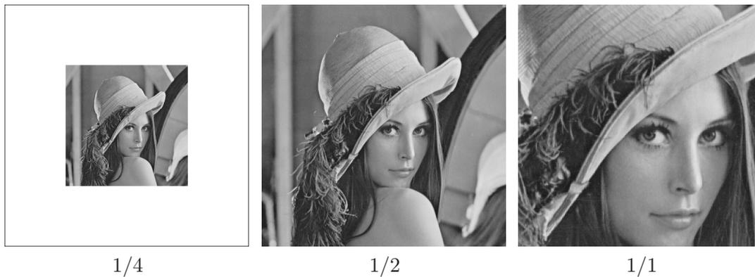
FIG. 1.1 – Scalabilité spatiale. Exemples de facteurs de résolution dyadiques obtenus avec le codec scalable JPEG-2000.
