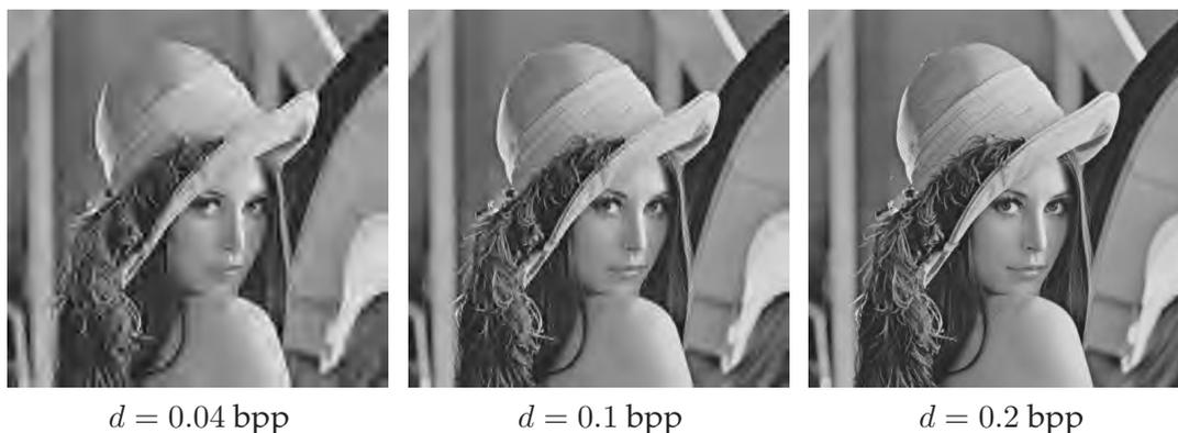
FIG. 1.2 – Scalabilité en qualité. Exemples de différentes qualités obtenues avec le codec JPEG-2000 lors du décodage à différents débits, exprimés en bits par pixel.
