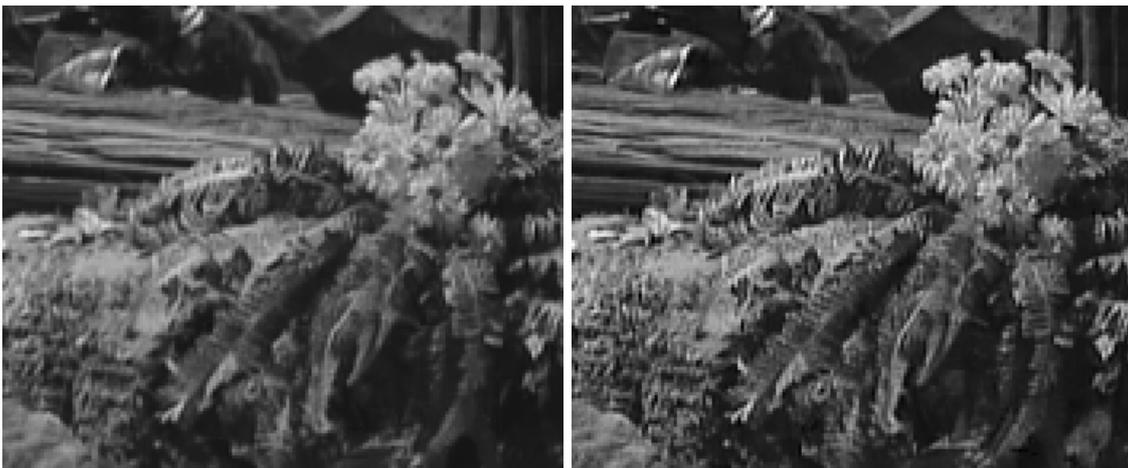
FIG. 3.7 – Zooms sur une région d'une image d'approximation du quatrième niveau temporel obtenu avec une transformée temporelle de Haar (gauche) et une transformée 5/3 (droite) sur la séquence *Tempête* au format CIF.
