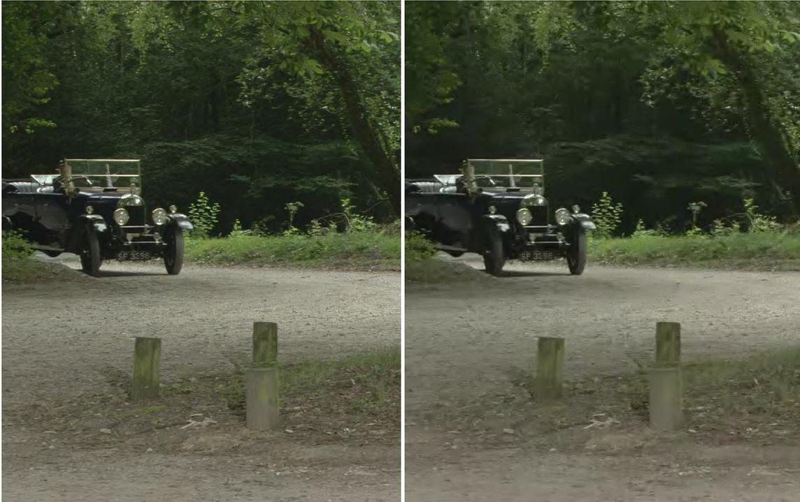
FIG. 4.8 – Reconstruction d’une image issue du codage de la séquence *Vintage Car* de résolution  $704 \times 896$  à 30 Hz pour un débit de 1024 kbs avec le codec Vidwav muni de l’estimation jointe (gauche) et avec le codec SVC JSVM 2.0 (droite).
