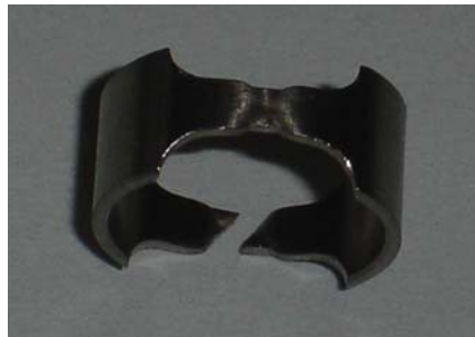
Figure 1 : Eprouvette de type anneau avec zone utile présentant néanmoins une localisation de la déformation.
