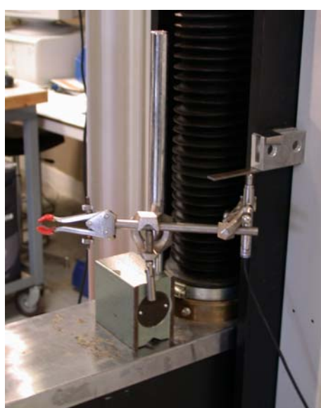
Figure 13 : A gauche : photo du montage utilisé pour que les mors soient dans un plan à 45^\circ par rapport à celui de la machine. A droite : photo du dispositif (comparateur) utilisé pour avoir accès au déplacement de la traverse mobile de la machine de traction.
