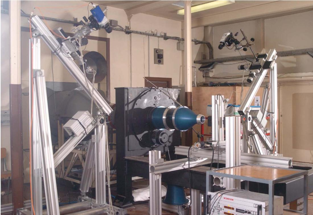
FIG. 7.5: Dispositif de PIV stéréoscopique installé dans la soufflerie R4Ch.
