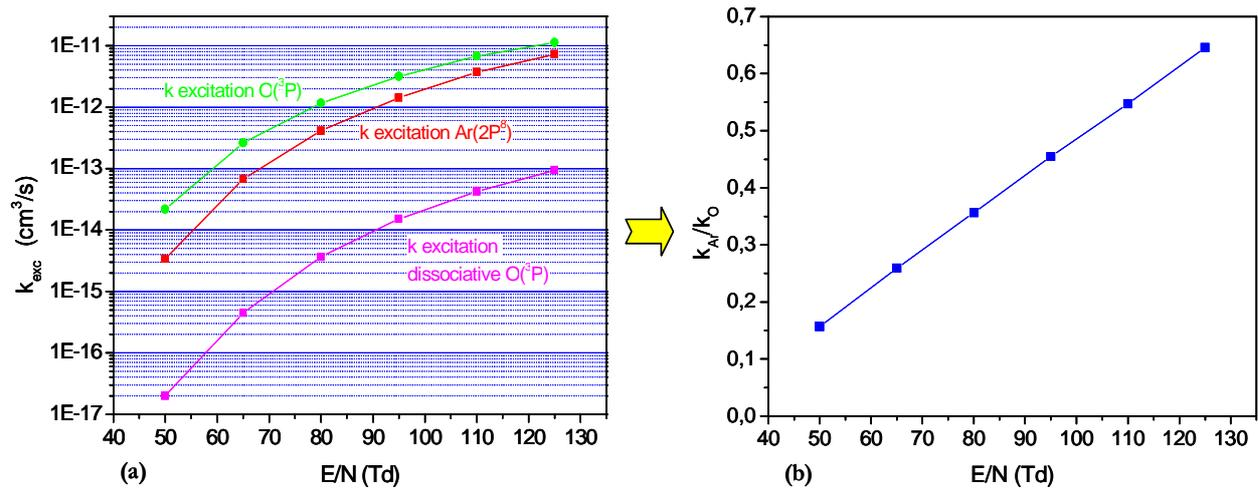
**Fig 4 : coefficient d'excitation de O et Ar (a) et leur rapport (b) en fonction du champ réduit, calculé à partir des FDEE de la Fig 3 et des sections efficaces de [Laher 90] et [Julienne 76] pour  $O^*$ , [Zapesochnyi 66] pour  $Ar^*$ , et enfin [Schulman 85] pour l'excitation dissociative**
