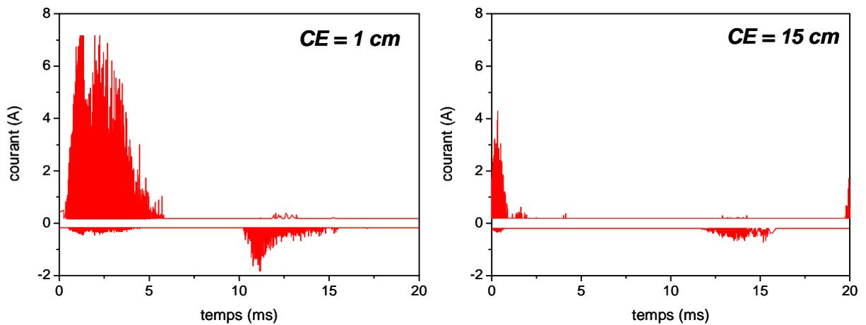
**Fig 21 : Mesure d'extrema pour deux longueurs de contre-électrode, dans l'air à 500 sccm avec 1000 ppm de  $C_2H_2$  et pour une tension appliquée de 19 kV**
