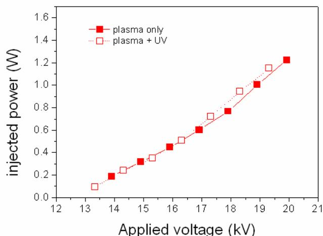
**Fig 35 : Effets des UV sur la puissance injectée dans l'air avec 1000 ppm de C<sub>2</sub>H<sub>2</sub>**
