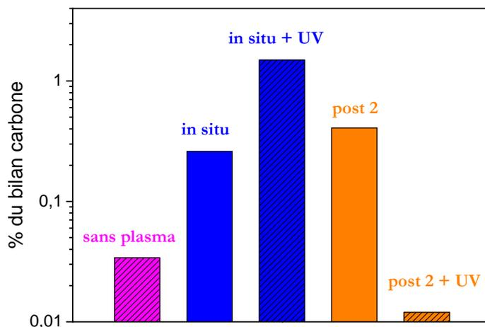
**Fig 39 : pourcentage du bilan carbone représenté par l'ensemble des acides détectés à la surface de Si20Ti20 en photocatalyse sans plasma, placé *in situ* avec et sans UV ou placé en post décharge avec et sans UV ( $P_{inj} = 0,2$  W,  $\phi = 500$  sccm air sec,  $[C_2H_2]_i = 1000$  ppm,  $P = 1$  bar)**
