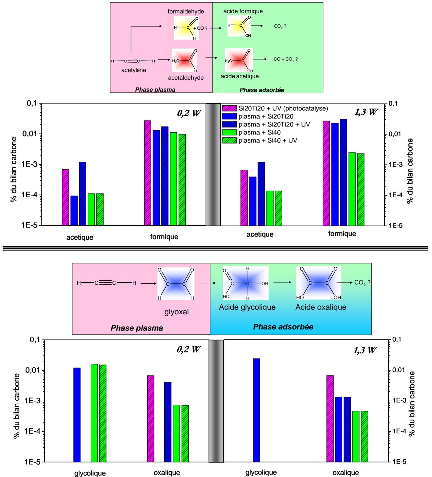
Fig 28 : concentration des 4 acides comportant 1 ou 2 atomes de carbone, sur  $Si_2O_2Ti_2O$  et sur  $Si_4O$ , avec et sans UV, pour 2 valeurs de tension appliquée (14 kV et 19 kV). Tous les échantillons sont exposés 30 min au plasma, sauf pour les barres roses pour lesquelles il n'y a pas de plasma (30 min de photocatalyse seule).
