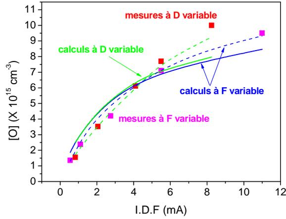
**Fig 14 : concentrations moyennes de O pendant les pulses calculées par intégration des résultats de la Fig 13 et tracées en fonction du courant moyen. Les résultats expérimentaux sont comparés au résultat de l'équation 25 calculée pour les mêmes jeux de paramètres I, D et F.**
