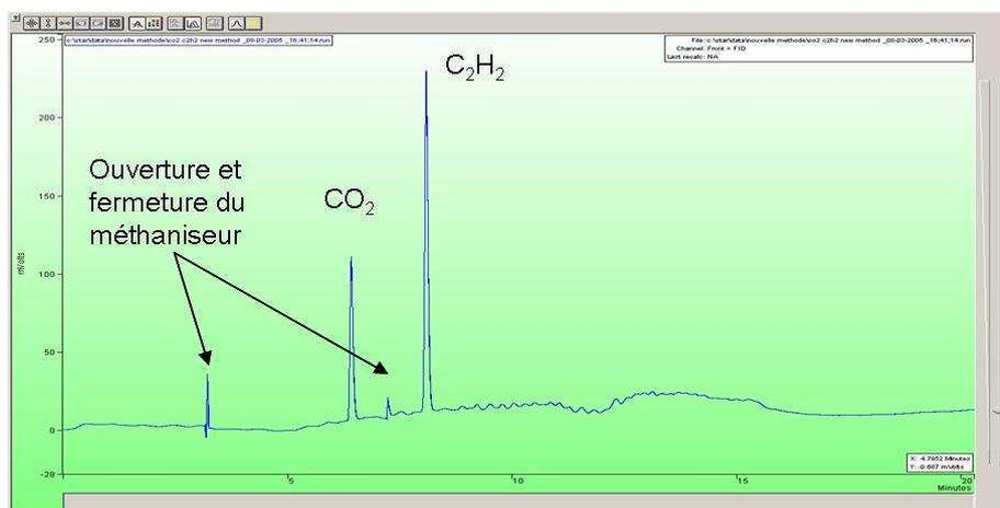
**Fig 11 : détection simultanée de 1000 ppm de CO<sub>2</sub> et 1000 ppm de C<sub>2</sub>H<sub>2</sub> lors d'une même injection. Les dépressions et surpressions générées par l'ouverture et la fermeture de la vanne du méthaneiseur occasionnent les pics qui entourent le pic de CO<sub>2</sub>**
