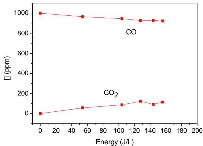
**Fig 14 : conversion de CO en  $CO_2$  en injectant dans la DBD de l'air avec 1000 ppm de CO.**
