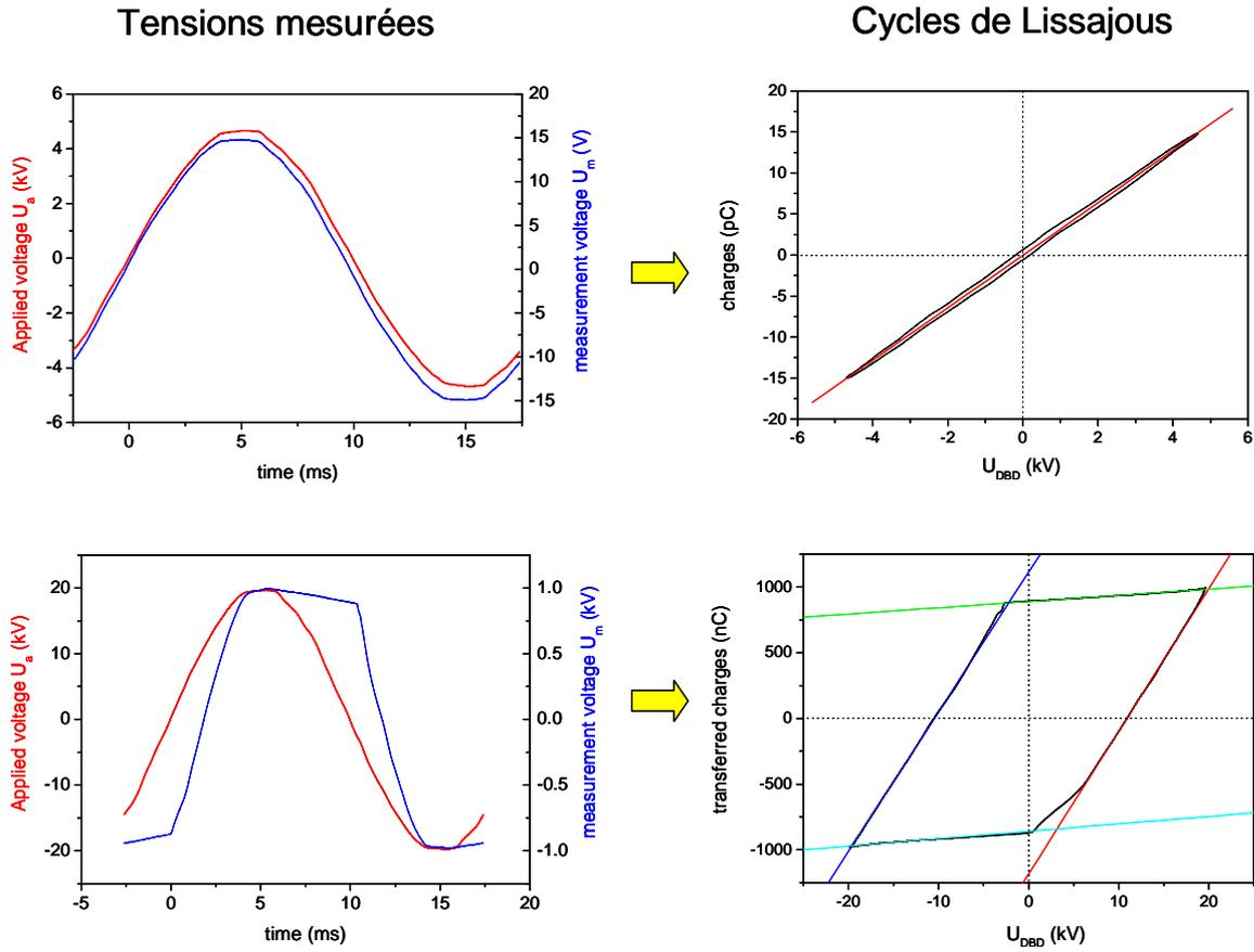
**Fig 9 : Exemples de tensions  $U_a$  et  $U_m$  mesurées avec les cycles de Lissajous associés. La première ligne est obtenue pour 4,8 kV appliqués et la deuxième ligne pour 20 kV appliqués**
