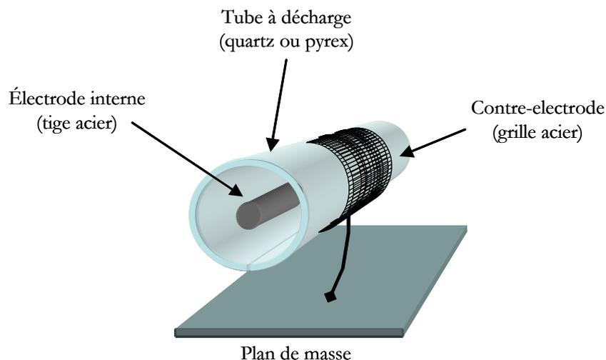
**Fig 1: structure coaxiale du réacteur de la DBD**
