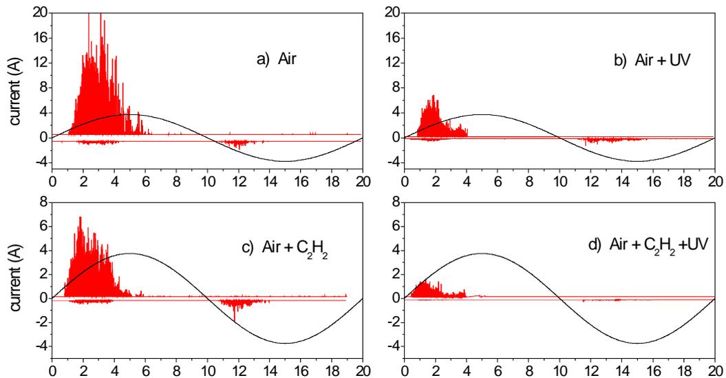
**Fig 34 : Extrema avec et sans UV, dans l'air seul et l'air + 1000 ppm de  $C_2H_2$  pour  $P = 0,62$  W**
