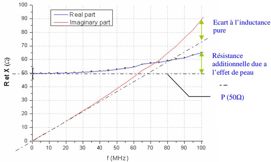
**Fig 2 : résultat de l'étalonnage avec l'analyseur de réseau**
