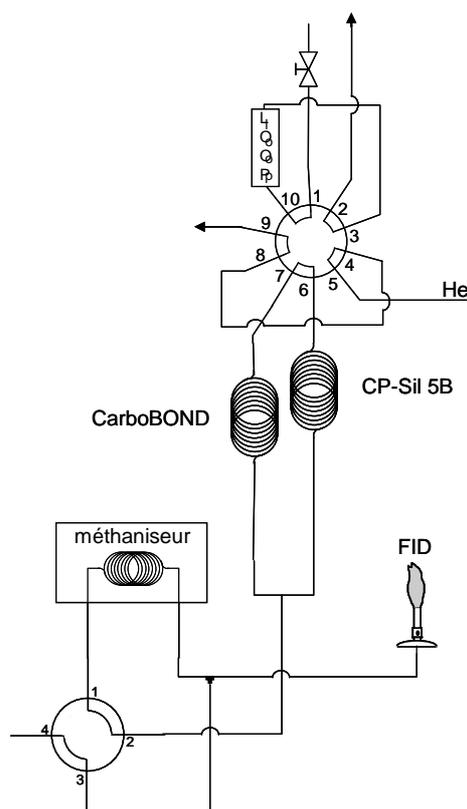
**Fig 10 : Schéma du nouveau montage à deux colonnes. Seule la colonne carboBOND est réellement utilisée pour séparer CO, CO<sub>2</sub> et C<sub>2</sub>H<sub>2</sub>**
