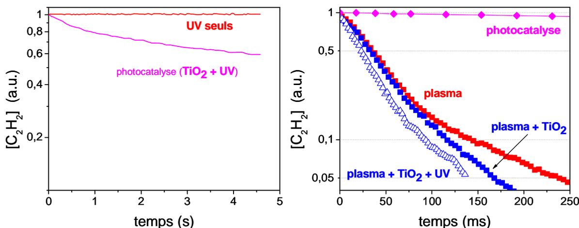
**Fig 32 a : destruction de  $C_2H_2$  sur plusieurs secondes avec UV externes en présence ou non de granules de  $TiO_2$ . Fig 32 b : destruction de  $C_2H_2$  pendant les 250 premières millisecondes d'amorçage du plasma ( $I = 3$  mA ,  $P = 1,6$  Torr, 20 g de pastilles de  $TiO_2$ )**
