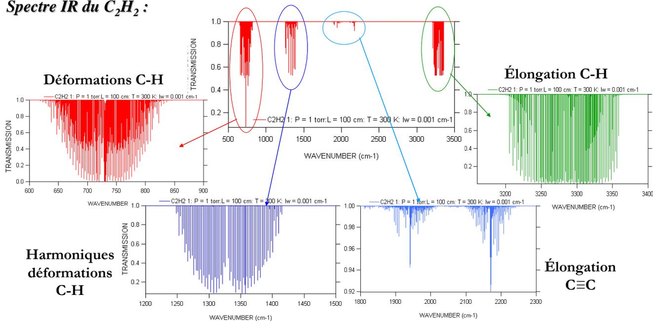
**Fig 25 : spectre de la molécule de  $C_2H_2$  dans l'infrarouge calculé à partir de la base de données HITRAN. Les bandes dues à l'élongation ou la déformation des liaisons  $C-H$  sont beaucoup plus intenses que celles dues à l'élongation de la triple liaison, beaucoup trop rigide pour avoir des modes très résonnants**
