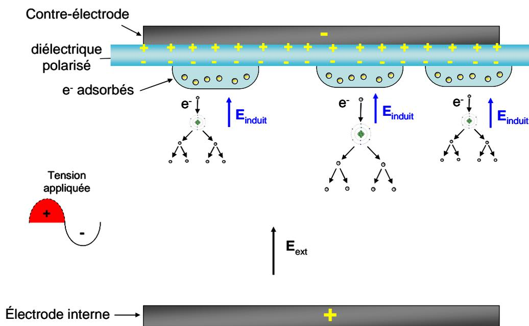
Les paquets de charges sont en phase de pré-amorçage
