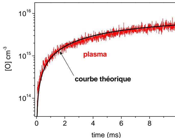
Fig 6 : production de O pendant un pulse de 10 ms à 1 Hz et 30 mA avec un flux d'air de 100 sccm et un flux d'argon de 10 sccm, P=1,6 Torr.
