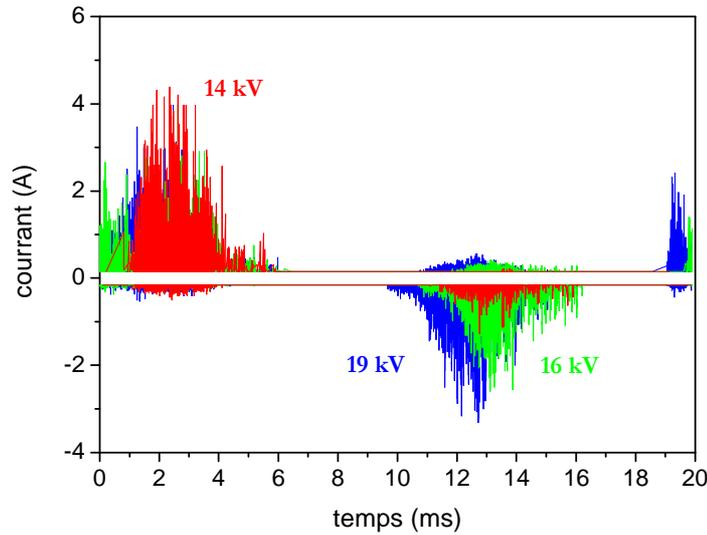
**Fig 25 : Extrema avec  $\text{TiO}_2$  dans les mêmes conditions que la Fig 24 . Air avec 1000 ppm de  $\text{C}_2\text{H}_2$  pour 14, 16 et 19 kV**
