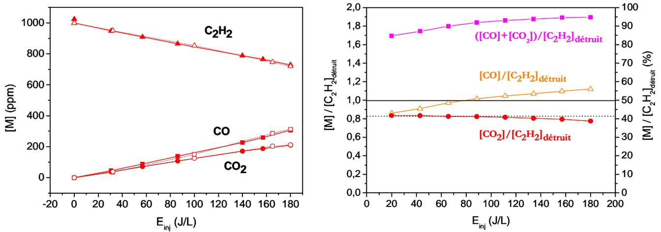
**Fig 10a : production de CO et  $CO_2$  dans les conditions de la Fig 1 ;**
