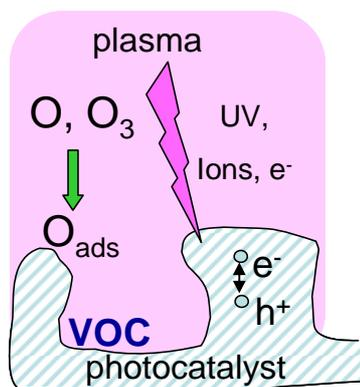
**Fig 2 : représentation des mécanismes vraisemblables de la synergie plasma/photocatalyse pour l'oxydation du  $\text{C}_2\text{H}_2$**
