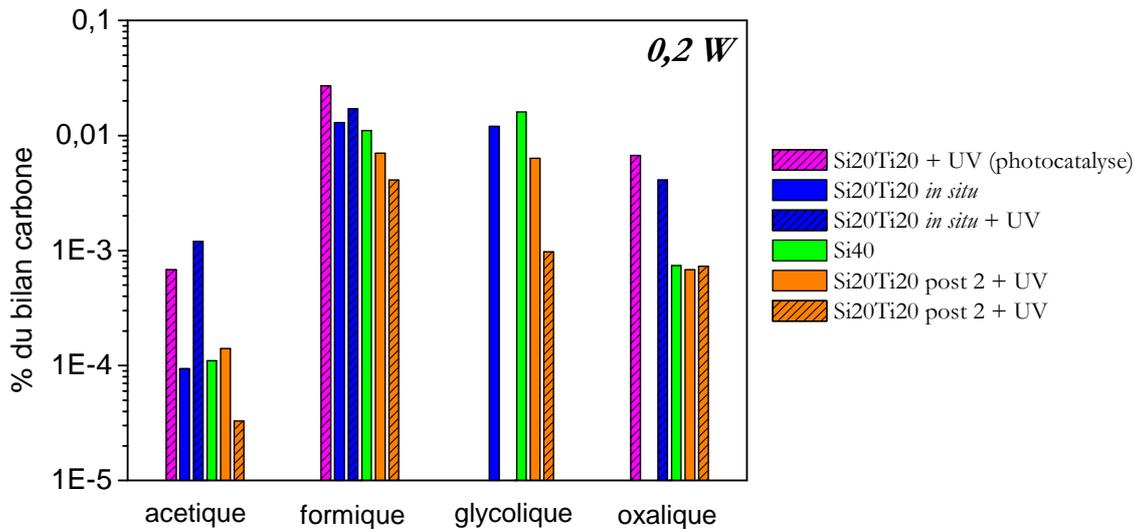
Fig 1 : comparaison des mesures d'acides adsorbés présentés à la avec les mesures effectuées sur Si<sub>20</sub>Ti<sub>20</sub> situé en post 2 (en orange) avec un plasma à 14 kV (0,2W).
