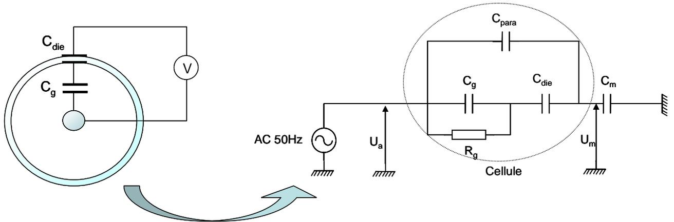
**Fig 8 : Schéma électrique de la DBD cylindrique**
