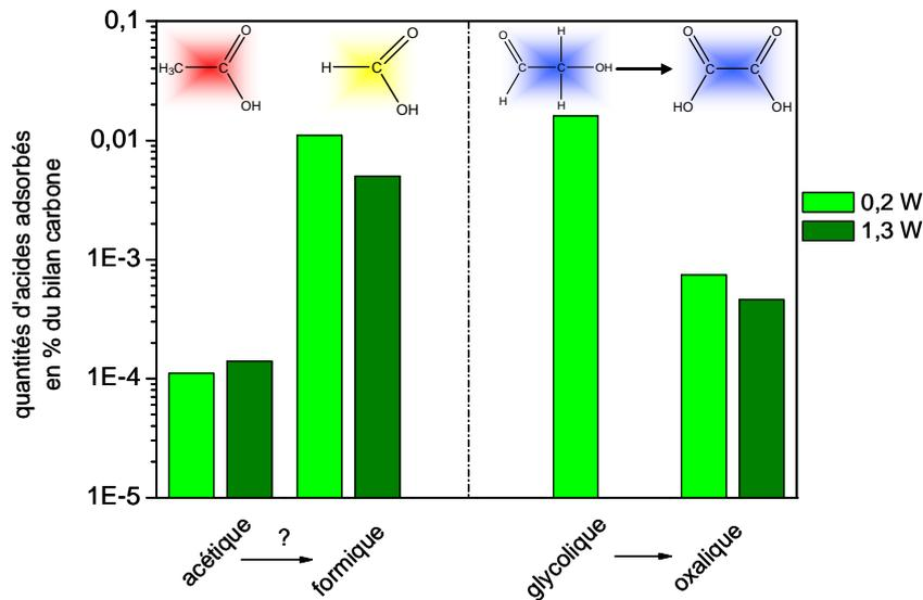
**Fig 22 : quantités rapportées en pourcentage du bilan carbone pour chacun des acides à 1 ou 2 carbones détectés à la surface de Si40 pour 0,2 et 1,3 W. L'acide acétique et l'acide formique à gauche correspondent à la première voie d'oxydation supposée en phase gaz tandis que l'acide glycolique et l'acide oxalique correspondent à la deuxième (cf. §2.2.2).**
