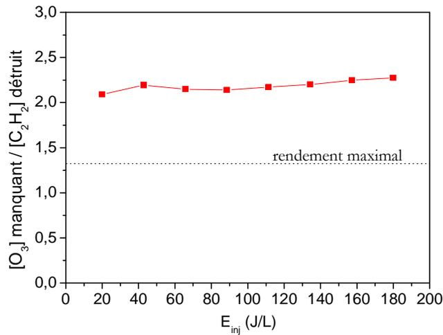
**Fig 3 : nombre de molécules de  $O_3$  manquantes (obtenu à partir de la Fig 2) divisé par le nombre de molécules de  $C_2H_2$  détruites en fonction de l'énergie injectée.**
