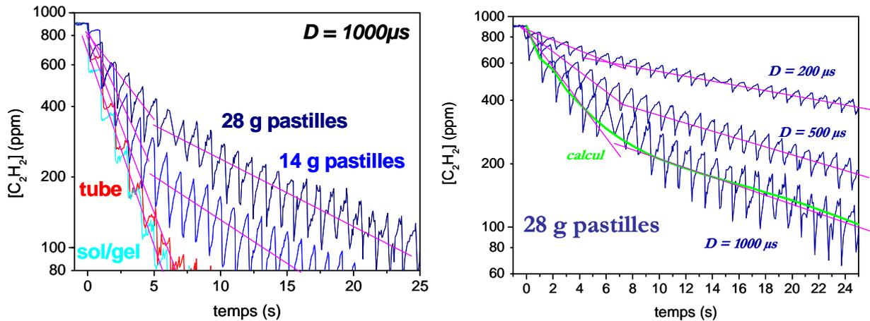
**Fig 29a :** courbes de destruction de  $C_2H_2$  pendant une série de pulses plasma de  $1000 \mu s$  avec différentes quantités de  $TiO_2$  (tube seul, dépôt sol/gel, 14 ou 28 g de granulés) représentées en échelle log pour faire apparaître les deux pentes existant avec les granulés de  $TiO_2$ .
