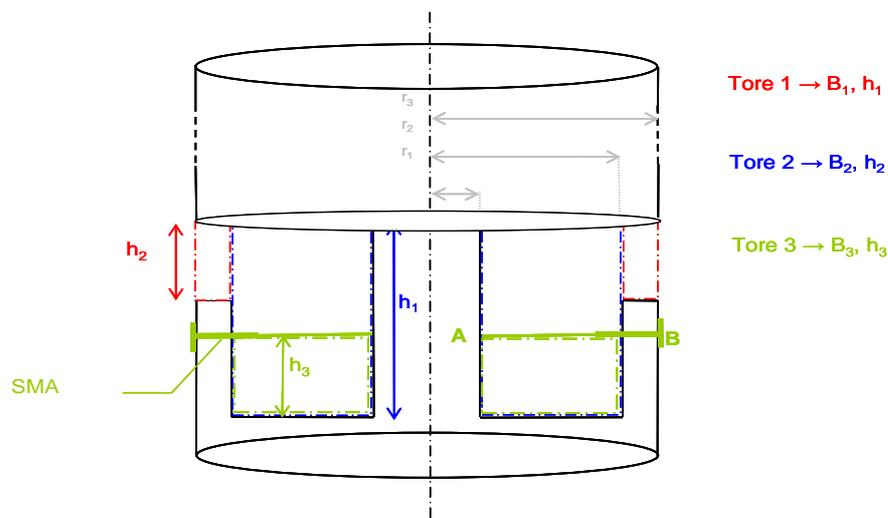
**Fig 8 : schéma de la sonde de courant fabriquée au laboratoire dans un cylindre en laiton**
