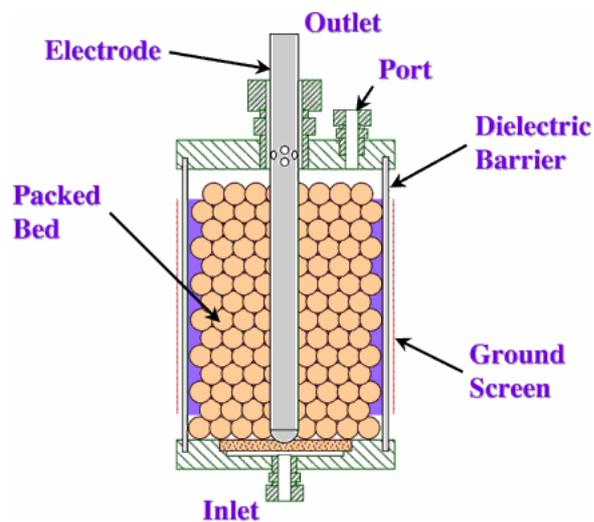
**Fig 17 : exemple de réacteur de DBD cylindrique à lit de catalyseur (packed bed reactor) commercialisé actuellement par une compagnie située à Washington (current environmental solution). Le catalyseur employé n'est pas précisé !**
