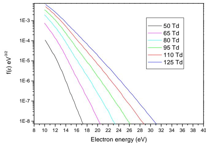
**Fig 3 : fonction de distribution en énergie des électrons dans un mélange 76 % N<sub>2</sub>, 19 % O<sub>2</sub> et 5 % Ar calculée par le code BOLSIG [1]**
