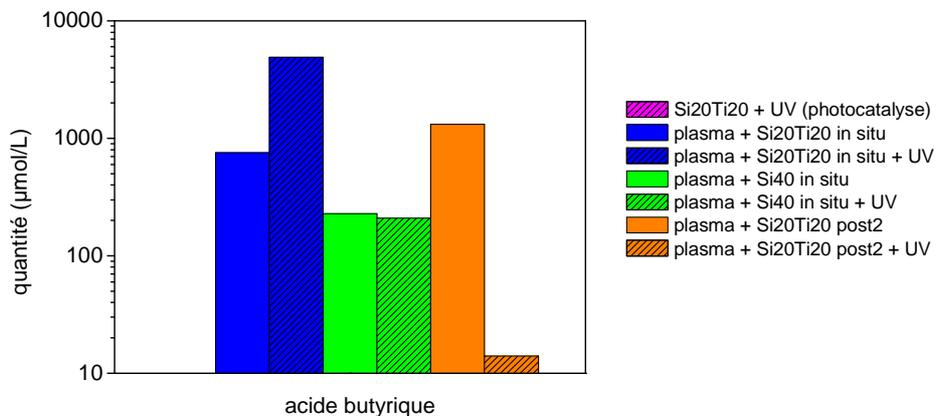
Fig 2 : quantités d'acide butyrique détecté sur Si<sub>20</sub>Ti<sub>20</sub> in situ et en post 2 et sur Si<sub>40</sub> in situ, avec et sans UV additionnels
