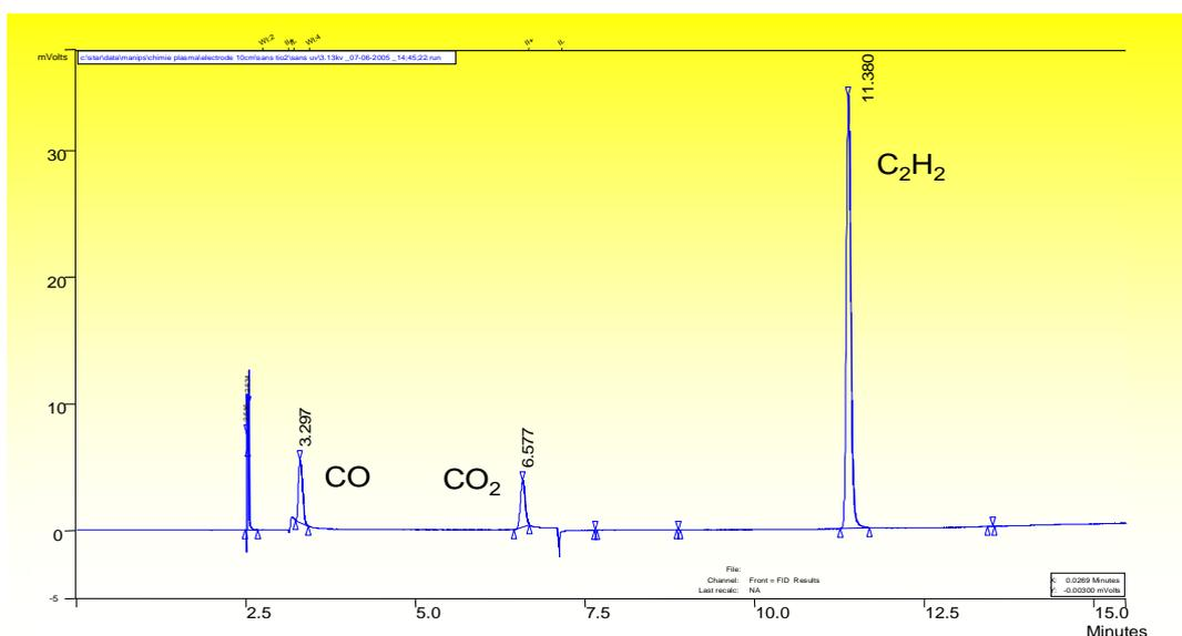
**Fig 12 : chromatogramme obtenu avec 165 ppm de CO, 140 ppm de CO<sub>2</sub> et 660 ppm de C<sub>2</sub>H<sub>2</sub>**
