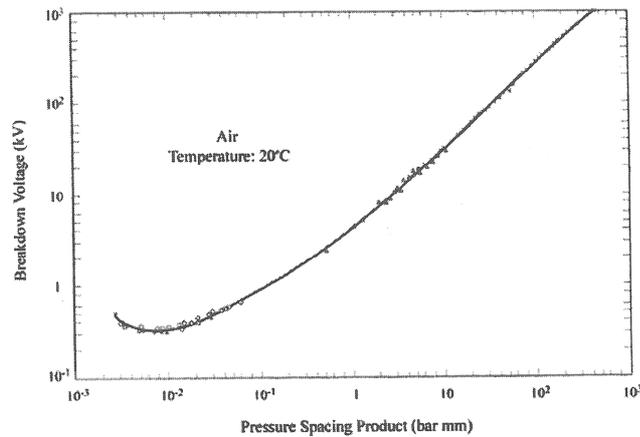
**Fig 8 : tension de claquage dans l'air sec en fonction du produit pression x distance inter-électrode d'après Dakin et al [Dakin 74]**
