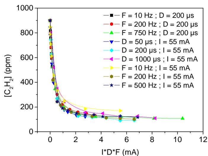
**Fig 16 : Courbes de destruction de  $C_2H_2$  par le plasma mesurées en faisant varier soit la fréquence, soit la durée des pulses, soit la courant de décharge, et tracées en fonction de courant moyen  $I \cdot D \cdot F$**
