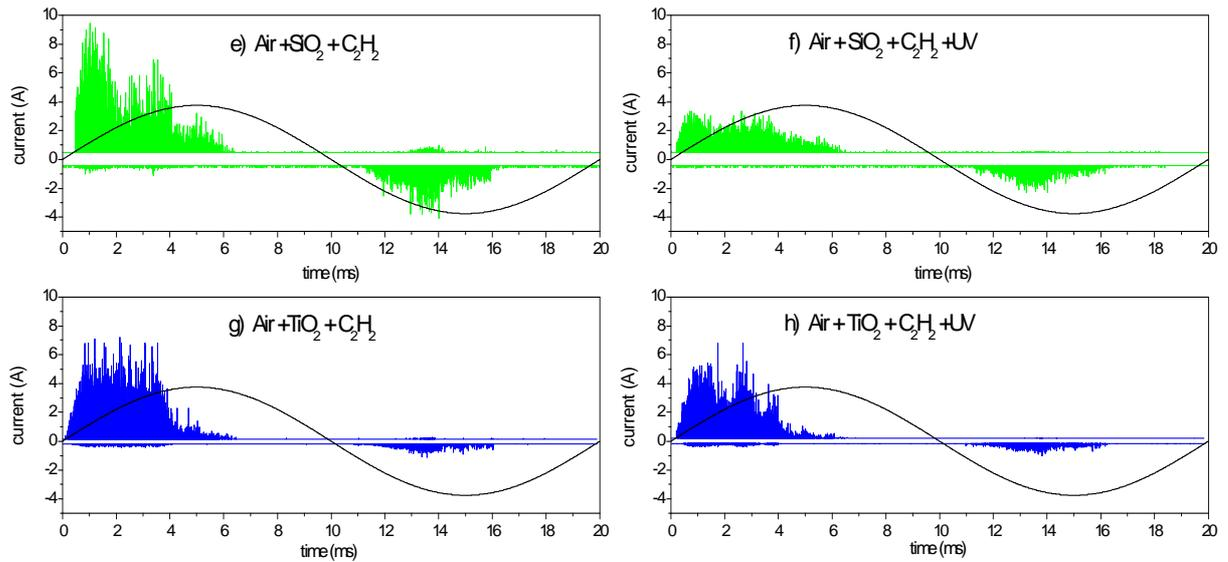
**Fig 36 : Extrema des pics de courant à 0,62 W dans l'air avec 1000 ppm de  $\text{C}_2\text{H}_2$ , avec ou sans UV, sur un matériau poreux non catalytique (Si40) et un matériau photocatalytique avec des particules de  $\text{TiO}_2$  (Si20Ti20)**
