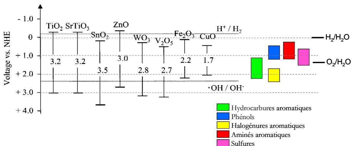
**Fig 19 : potentiels redox des bandes de valences et des bandes de conductions de quelques photocatalyseurs classiques comparés d'une part aux potentiels redox des couples d'espèces liées à l'eau, et d'autre part aux domaines de potentiels redox de familles de molécules souvent traitées par photocatalyse. D'après [Miyachi 02] et valeurs du NIST**
