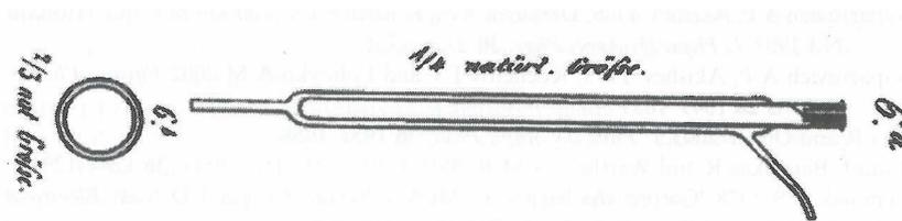
**Fig 6 : schéma de l'ozoneur de Siemens en 1857. Il s'agit d'un réacteur de DBD cylindrique [Siemens 57]**
