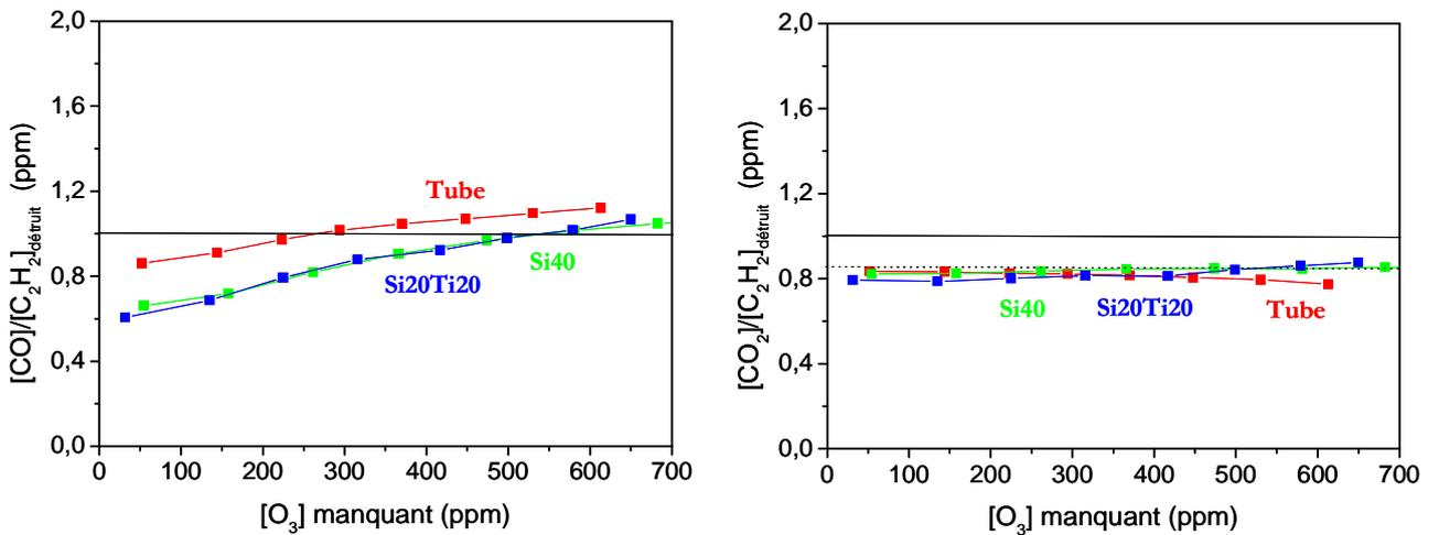
**Fig 35 : rendement de conversion du  $C_2H_2$  détruit en CO et  $CO_2$  en fonction de l'ozone manquant (différence calculée à partir des mesures dans l'air et dans l'air avec  $C_2H_2$ ) dans le tube sans matériau, et avec Si40 ou Si20Ti20 placé *in situ***
