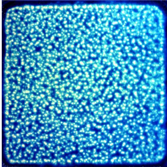
**Fig 7 : les filaments s'amorcent aléatoirement dans le temps et l'espace mais en moyenne ils recouvrent toute la surface des électrodes. Filaments obtenus avec des électrodes carrées de 6 cm de côté. [Kogelschatz 03]**
