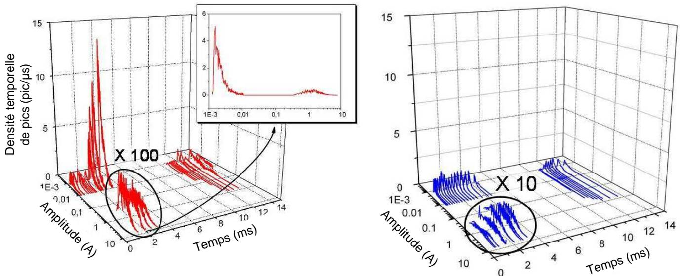
**Fig 28 : fonction de distribution en amplitude résolue en temps des pics de courant avec et sans  $\text{TiO}_2$  pour  $P = 0,62 \text{ W}$ . Les 10 premières millisecondes représentent la demi-période positive de l'alimentation, avec l'électrode centrale positive. La période dure 20 ms mais les graphes sont interrompus à 15 ms afin d'améliorer la lisibilité car aucun pic n'intervient entre 15 et 20 ms**
