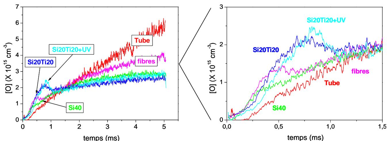
**Fig 23 : étude des effets d'adsorption/désorption de O sur la surface des catalyseurs précédemment utilisés dans la DBD : fibres, Si40 et Si20Ti20. D = 5 ms, F = 1 Hz, I = 50 mA, P = 1,6 Torr, flux total = 30 sccm. Le graphique de droite est un agrandissement des premières ms de pulse.**
