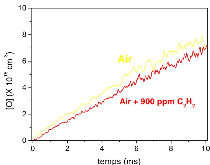
**Fig 15 : mesure de O pendant un pulse plasma de 10 ms, avec un courant de 30 mA et une fréquence de 1 Hz. Le flux de gaz est constitué de 10 sccm d'air et 1 d'Ar pour les mesures dans «l'air» et 9 sccm d'air, 1 sccm de C<sub>2</sub>H<sub>2</sub> à 1% dans N<sub>2</sub> et 1 sccm de Ar pour les mesures avec C<sub>2</sub>H<sub>2</sub>. Le gaz est renouvelé entre deux pulses. La pression est de 2,4 Torr.**
