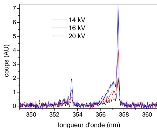
**Fig 6 : Evolution de l'intensité lumineuse des deux bandes du second système positif de  $N_2$  dont le signal est le plus intense, pour 14, 16 et 20 kV appliqués, avec les mêmes conditions d'acquisition des spectres**
