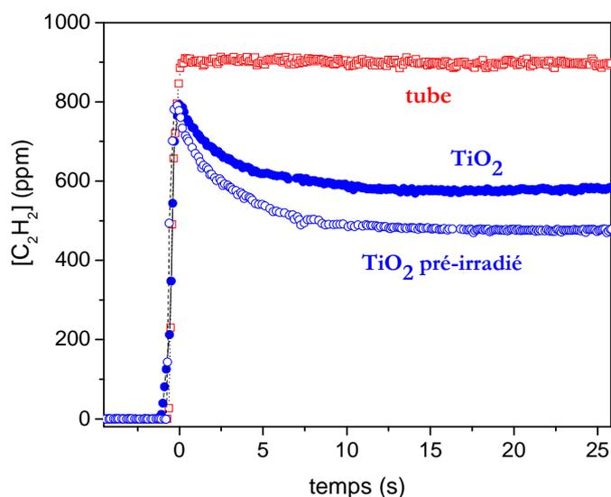
**Fig 31** mesure de la concentration de  $C_2H_2$  dans la phase gaz au cours de la procédure de remplissage dans le tube à décharge, avec ou sans granulés de  $TiO_2$  ( $P = 1,6$  Torr, 20 g de pastilles de  $TiO_2$ )
