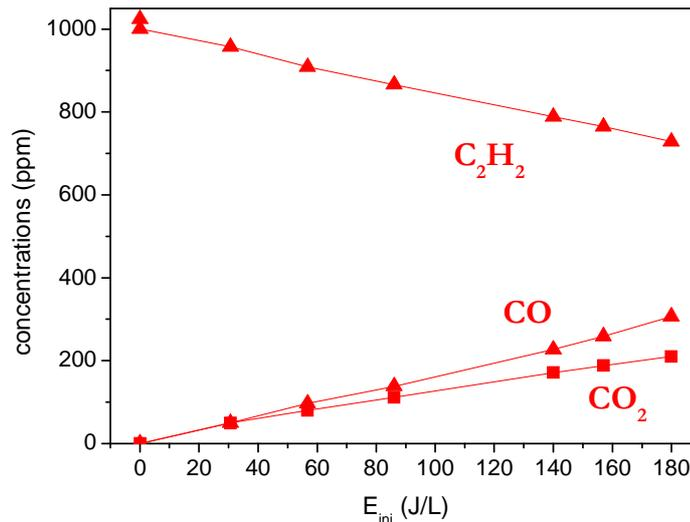
**Fig 1 : destruction du  $C_2H_2$  et production de CO et  $CO_2$  en fonction de l'énergie injectée dans le gaz. Courbes obtenues par chromatographie pour 500 sccm de flux, 1000 ppm de  $C_2H_2$ , la tension variant entre 14 et 20 kV.**
