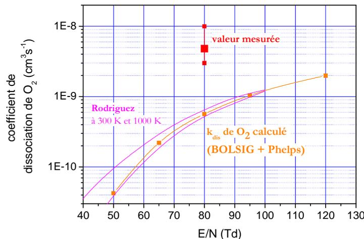
**Fig 7: coefficient de dissociation de O<sub>2</sub> par impact électronique en fonction du champ réduit calculé à partir des sections efficaces de Phelps et al [Phelps 85] et des FDEE calculées par le code BOLSIG et résultat du code de Rodriguez et al à 300 et 1000 K [Rodriguez 91]. Le point rouge donne la valeur obtenue à partir de la courbe de la Fig 6**
