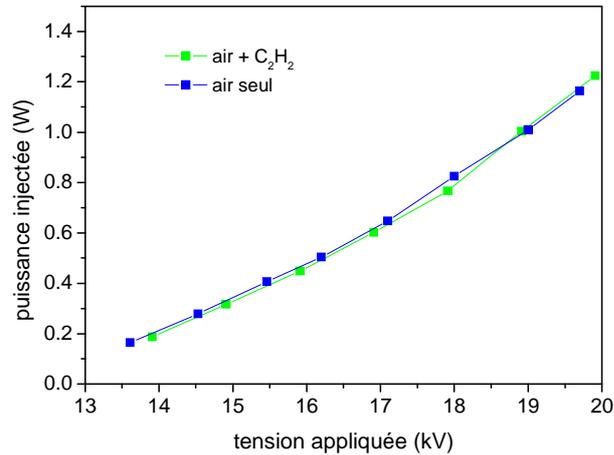
Fig 18 : Comparaison des puissances injectées avec et sans  $C_2H_2$  (1000 ppm)
