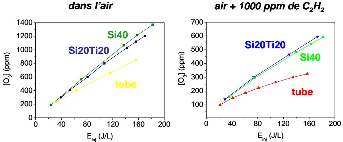
Fig 31 : production de  $O_3$  avec Si20Ti20, Si40 ou sans matériau ( $C_2H_2 = 0$  ou 1000 ppm, flux = 500 sccm)
