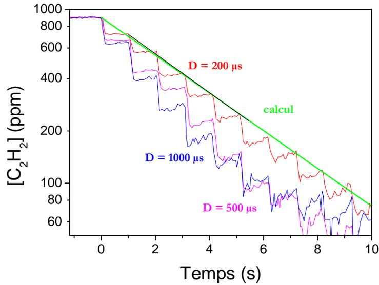
**Fig 20: destruction de C<sub>2</sub>H<sub>2</sub> pendant une série de pulses pour trois durées différentes (D = 200, 500 et 1000 µs), sans flux de gaz et avec une concentration initiale de 900 ppm, F = 1 Hz, I = 55 mA P = 2,4 Torr**
