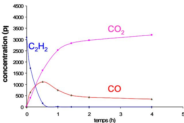
Fig 12 : cinétique de destruction de C<sub>2</sub>H<sub>2</sub> par le plasma pour une puissance de 0,22 W dans le réacteur en recirculation du LACE
