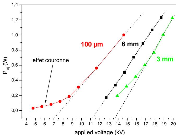
**Fig 12 : Puissance injectée en fonction de la tension appliquée pour trois diamètres de l'électrode interne : 100  $\mu\text{m}$ , 3 et 6 mm. (air sec 500 sccm, tube en quartz 1,5 cm de diamètre, contre-électrode de 10 cm)**
