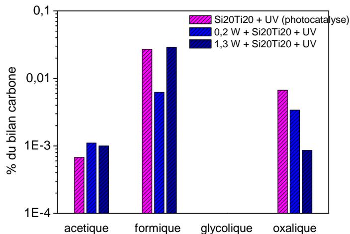
**Fig 29 : comparaison des quantités d'acides sur Si20Ti20 dues à l'irradiation par des UV externes exprimée en pourcentage du bilan carbone pour 0,2 et 1,3 W. Ces quantités sont estimées en soustrayant les quantités obtenues sans UV de celles obtenues avec UV**
