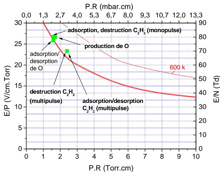
**Fig 1 : variation du champ réduit avec le produit pression.rayon du tube à décharge extraite de [Raizer 91]. Les points correspondent aux champs réduits des différentes séries de mesures présentées dans ce chapitre**
