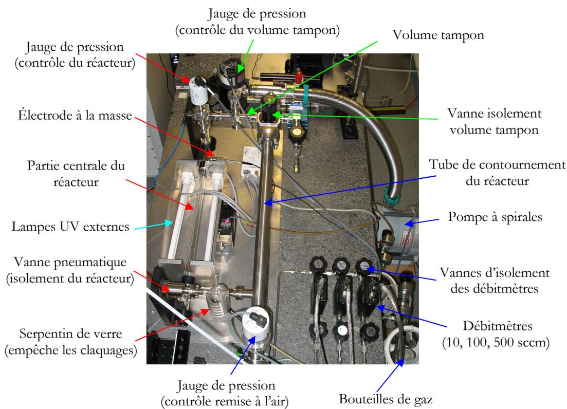
**Fig 19 : dispositif expérimental ultravide autorisant les études en statique sans fuite. Les flèches rouges correspondent aux parties relatives au réacteur lui-même, les vertes au volume tampon, et les bleues au reste du circuit de gaz.**
