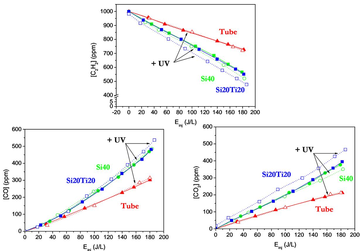
**Fig 24 : destruction de  $\text{C}_2\text{H}_2$  et production de CO et  $\text{CO}_2$  en fonction de la densité d'énergie. Les mesures sont effectuées avec et sans UV externes (pointillés), avec Si40 (vert), Si20Ti20 (bleu) ou sans matériau dans le tube (rouge), avec un flux d'air de 500 sccm contenant 1000 ppm de  $\text{C}_2\text{H}_2$  initial.**
