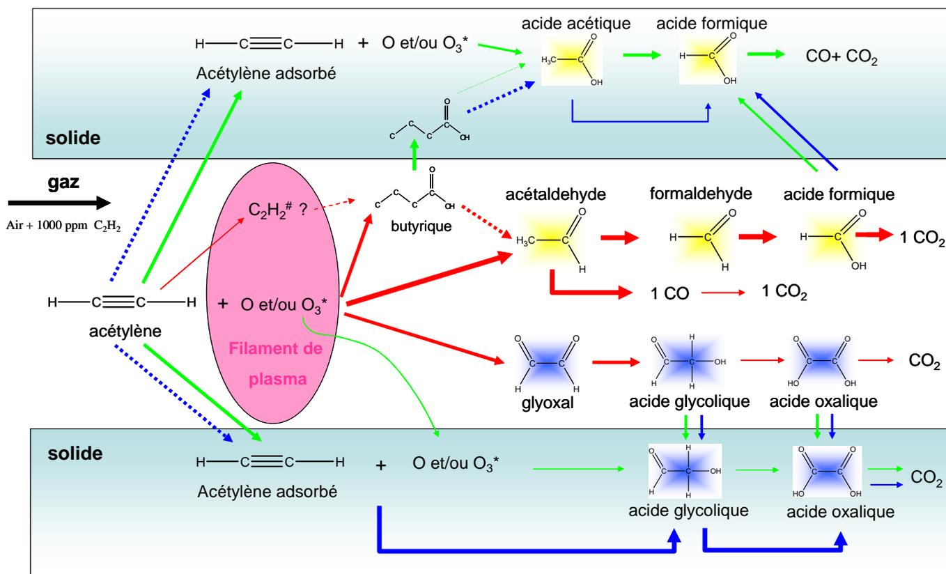
**Fig 40 : bilan des interactions chimiques entre le plasma et la surface poreuse du catalyseur. Les flèches rouges correspondent aux mécanismes de la phase gaz, les vertes au mécanismes de surface, et les bleues aux mécanismes spécifiques de la photocatalyse.**
