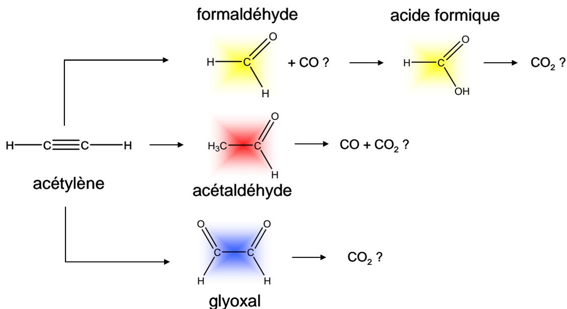
**Fig 15 : acides et aldéhydes identifiés dans la phase gaz en post décharge. Deux ou trois voies d'oxydation coexistent. Les flèches ne correspondent pas à une seule réaction mais regroupent elles mêmes probablement une série de réactions.**
