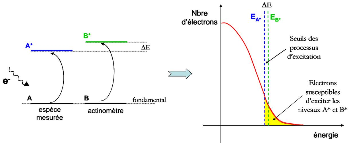
**Fig 1 : schéma représentant l'excitation d'un niveau A\* de l'espèce mesurée et d'un niveau B\* de l'actinomètre. Lorsque A\* et B\* sont proches en énergie, les électrons du plasma susceptibles de les exciter sont les mêmes.**
