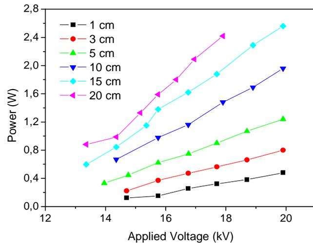
**Fig 13 : Puissance injectée en fonction de la tension appliquée pour six longueurs de contre-électrode. Conditions : air à 500 sccm, tube pyrex 1,5 cm de diamètre interne, scotch aluminium comme contre-électrode, électrode interne 3 mm**
