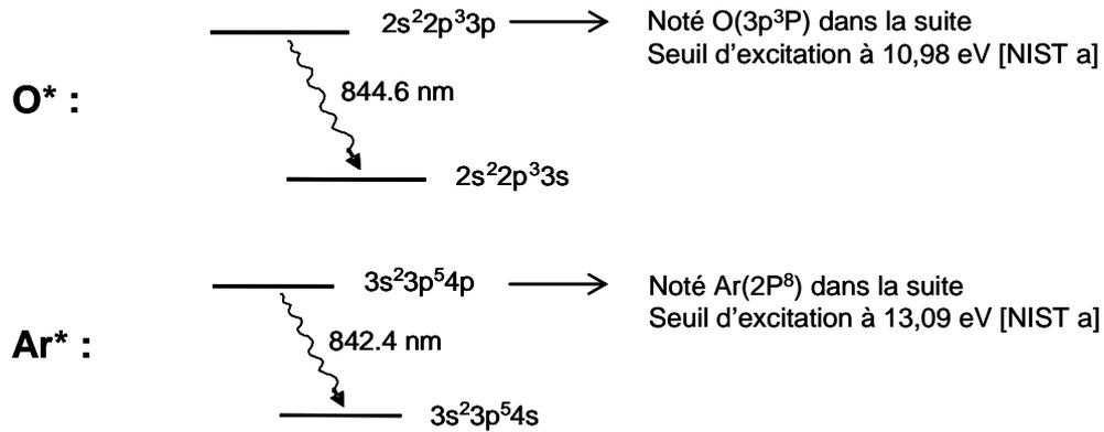
Fig 2 : schématisation des transitions à 844,6 nm de O et à 842,4 nm de Ar
