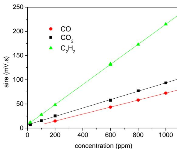
**Fig 13 : étalonnage pour CO, CO<sub>2</sub> et C<sub>2</sub>H<sub>2</sub>**
