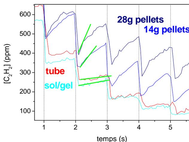
**Fig 30:** zoom sur les oscillations des courbes de la Fig 29a ( $D = 1000 \mu\text{s}$ ). Les traits verts permettent de comparer les pentes de désorption de C<sub>2</sub>H<sub>2</sub> en fonction des différentes surfaces considérées (tube, dépôt sol/gel, 14 ou 28 g de granulés de TiO<sub>2</sub>)
