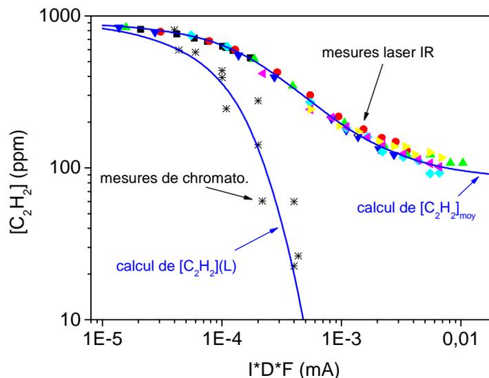
**Fig 19 :** comparaison de la concentration calculée à partir de l'équation (35) pour une valeur de  $\alpha/V$  égale à  $160 \text{ cm}^{-1} \cdot \text{A}^{-1}$ , avec les mesures d'absorption IR de la Fig 16 et des mesures par chromatographie en phase gaz obtenues en faisant varier  $I$ ,  $D$  et  $F$  sur les mêmes gammes que pour les mesures laser
