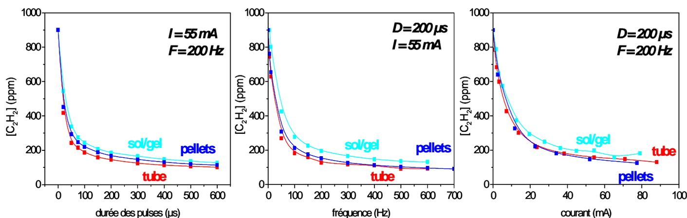
Fig 27 : comparaison des courbes de destruction de C<sub>2</sub>H<sub>2</sub> obtenues avec et sans TiO<sub>2</sub> (dépôt sol gel ou TiO<sub>2</sub> Alfa Aesar commercial) en fonction de D, F et I
