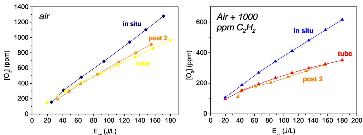
**Fig 32 : mesure de la concentration d'ozone avec Si20Ti20 sans UV placé dans la décharge (in situ) ou 10 cm après la zone de décharge (post 2). Cette position correspond au fait que le gaz arrive au contact de Si20Ti20 2 s après être sorti de la zone plasma.**
