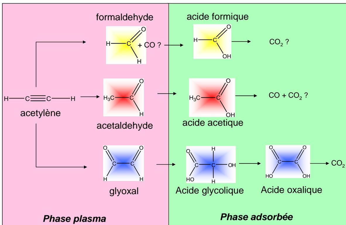
**Fig 21 : les acides identifiés sur le Si40 correspondent aux deux voies d'oxydation envisagées avec les aldéhydes mesurés en post décharge avec le plasma seul**
