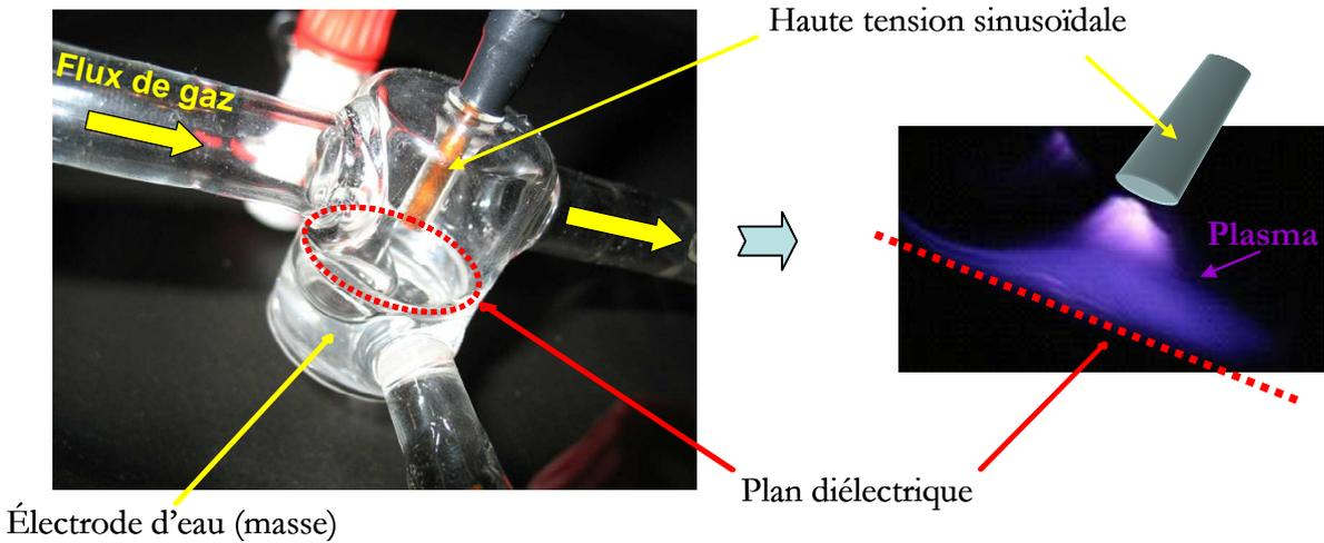
**Fig 38 : réacteur de la DBD petit plan métallique/grand plan diélectrique**
