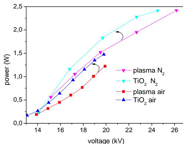
**Fig 19 : Puissance injectée en fonction de la tension appliquée avec et sans TiO<sub>2</sub>, dans un milieu avec une chimie d'oxydation (air + 1000 ppm de C<sub>2</sub>H<sub>2</sub>) ou dans un milieu chimiquement inerte (N<sub>2</sub> pur)**
