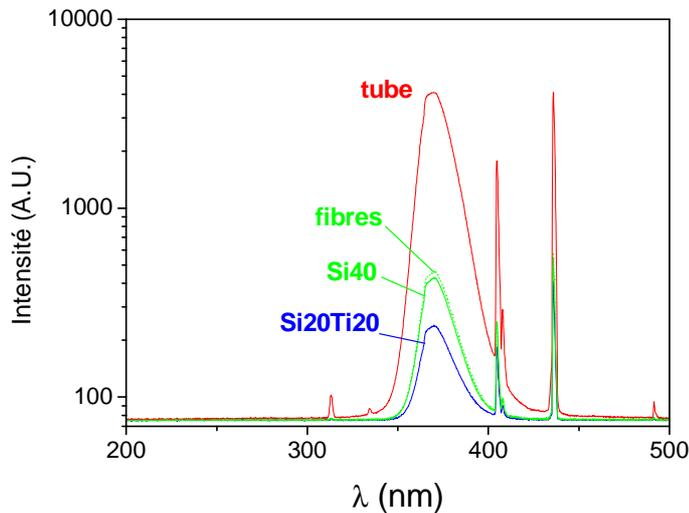
**Fig 37 :** intensité lumineuse des lampes UV externes. Le flux transmis au travers des fibres, de Si40 et Si20Ti20 est obtenu en intercalant entre les lampes et le spectromètre un morceau de catalyseur identique à celui utilisé pour les mesures de chimie.
