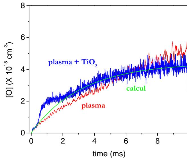
**Fig 22 : comparaison des productions de O atomique avec ou sans pastilles de TiO<sub>2</sub> pendant un pulse plasma de 10 ms à 1 Hz et 30 mA, avec un flux de gaz de 100 sccm d'air et 10 sccm de Ar. La courbe verte est calculée à partir de l'équation (18)**
