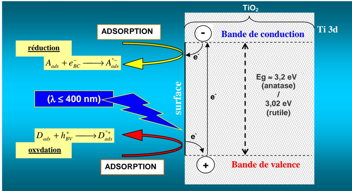
Fig 18 : schéma de principe des réactions photocatalytiques dans le cas du TiO<sub>2</sub>
