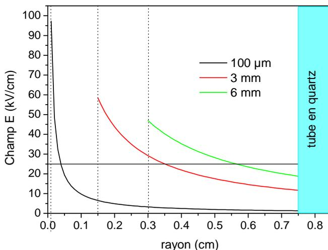
**Fig 11 : Champ électrique juste avant le premier amorçage pour des électrodes internes de 100  $\mu\text{m}$ , 3 mm et 6 mm de diamètre. Les tensions de claquage observées expérimentalement et utilisées pour le calcul du champ sont respectivement 4,2 kV, 14,1 kV et 12,9 kV**
