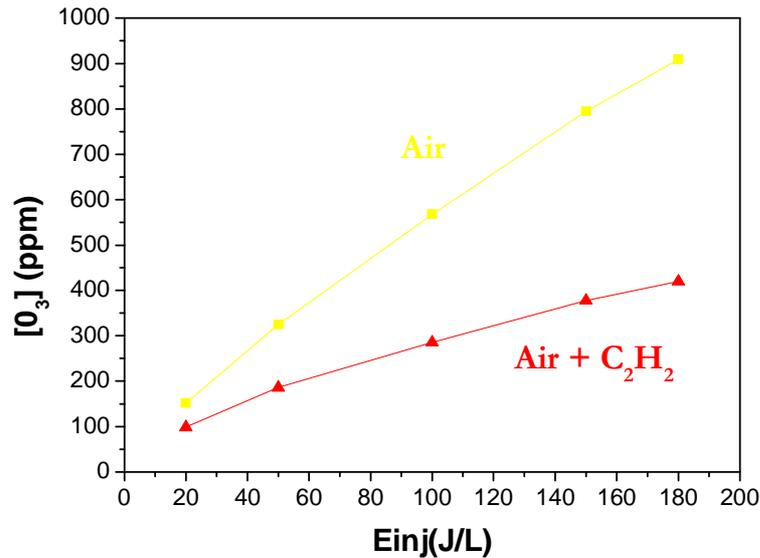
**Fig 2 : concentration d'ozone mesurée par absorption UV large bande en post décharge (3 s après le réacteur) avec les mêmes conditions de plasma que pour la Fig 1 dans l'air seul et dans l'air avec 1000 ppm de  $C_2H_2$ .**
