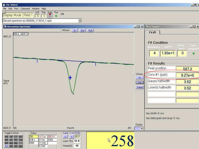
**Fig 31 : saisie d'écran de l'interface de TDL Wintel avec une raie d'absorption de C<sub>2</sub>H<sub>2</sub> (1359,28 cm<sup>-1</sup>), le fit du logiciel et la concentration calculée entourée en rouge.**
