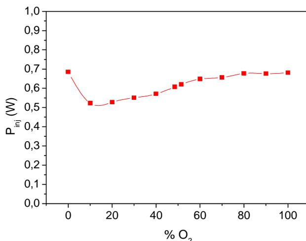
**Fig 17 : Puissance injectée en fonction de la proportion N<sub>2</sub>/O<sub>2</sub> pour U<sub>a</sub> = 16 kV**
