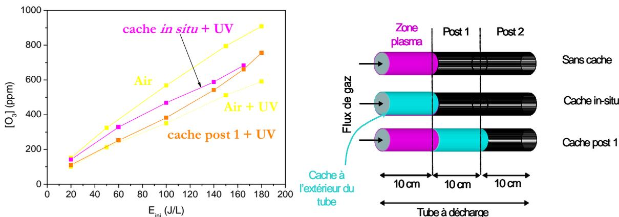
**Fig 7 : Effet des UV sur la production de O<sub>3</sub> dans l'air en ajoutant un cache à l'extérieur du tube à décharge soit autour de la zone de décharge, soit juste après la zone de décharge (post 1)**
