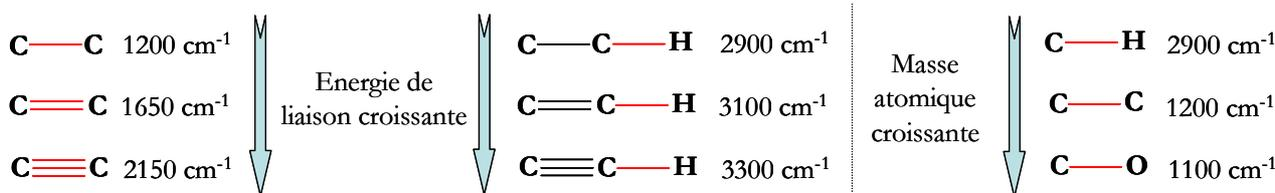
Fig 24 : quelques exemples de liaisons classées en fonction de l'énergie de liaison ou de la masse atomique de éléments impliqués et des valeurs typiques de nombre d'onde (proportionnels à l'énergie) associées à l'élongation de ces liaisons
