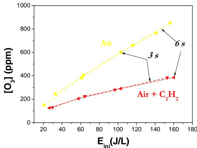
**Fig 4 : concentration d'ozone mesurée 3s et 6 s après la décharge pour les mêmes conditions de plasma que pour la Fig 2**
