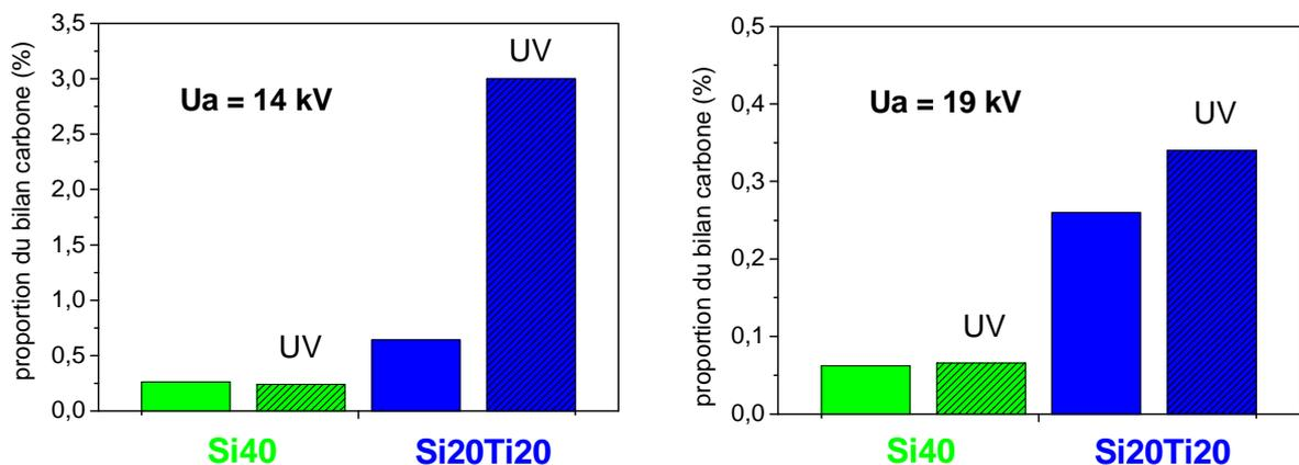
Fig 27 : quantités d'acides mesurées sur les surfaces de Si40 et Si20Ti20, exprimée en pourcentage du bilan carbone pour deux valeurs de tension appliquée (14 et 19 kV), avec et sans UV additionnels
