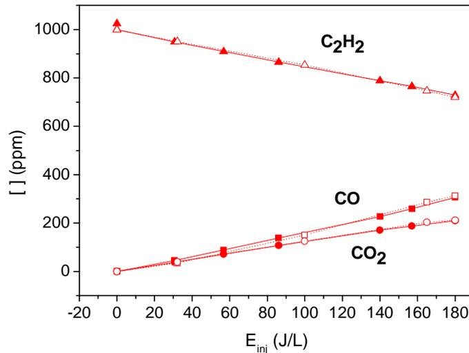
**Fig 8 : effet des UV externes sur la destruction du  $C_2H_2$  et son oxydation en CO et  $CO_2$ . Les mesures avec UV sont représentées en pointillés et symboles ouverts.**
