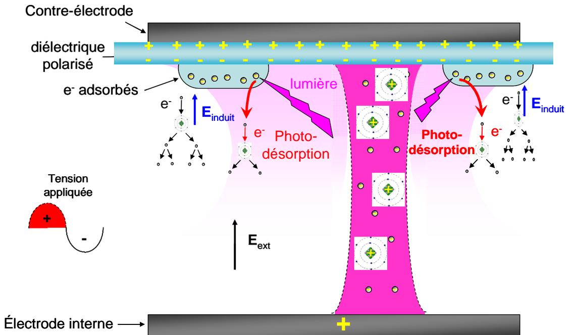
**Fig 32 :** le départ d'une grande quantité de charges adsorbées grâce à la photo-désorption est à l'origine d'un grand pic de courant : c'est « l'effet collectif »
