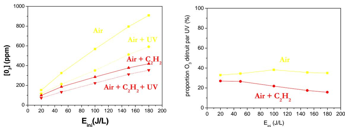
**Fig 6a : effet des UV additionnels sur la production d'ozone dans l'air et dans l'air + 1000 ppm de  $C_2H_2$ .
