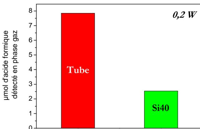
**Fig 19 : quantité relative d'acide formique dans la phase gaz avec et sans Si40 dans la décharge**
