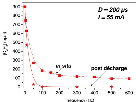
**Fig 17: comparaison des mesures effectuées in situ par spectroscopie d'absorption IR et en post décharge par chromatographie en phase gaz.**
