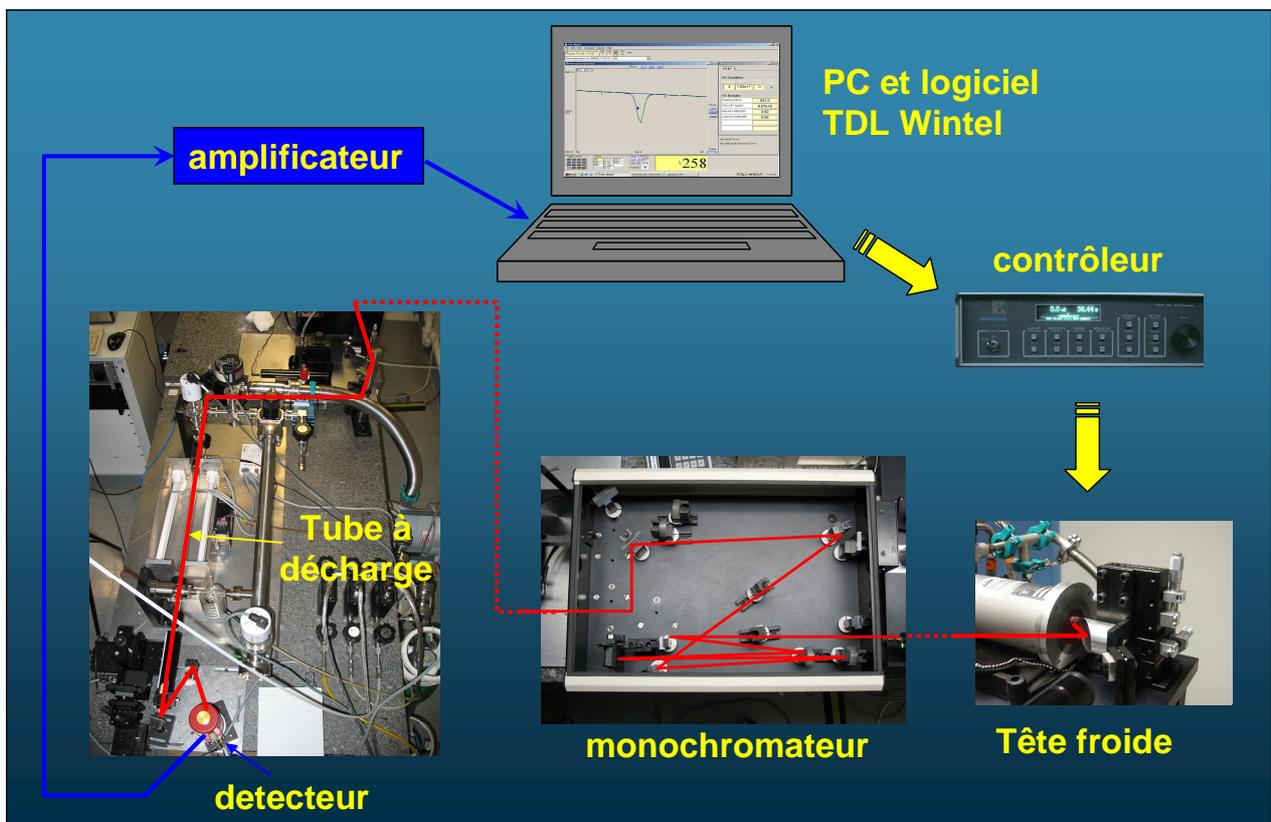
Fig 26 : Ensemble du dispositif expérimental relatif au laser à diodes
