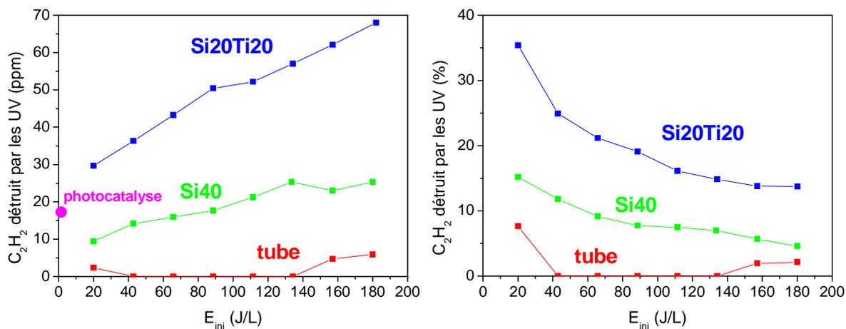
**Fig 25 : importance de l'effet des UV externes sur la destruction du  $C_2H_2$ . Le graphe de gauche donne le nombre de ppm détruits par les UV. Le graphe de droite est renormalisé par la quantité totale de  $C_2H_2$  détruit ce qui donne l'importance de la photocatalyse sur la destruction en pourcentage.**
