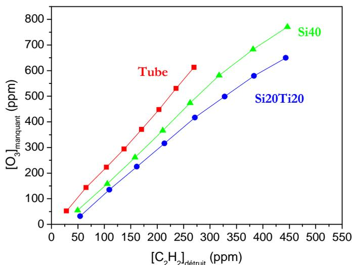
**Fig 34 : comparaison des quantités d'ozone qui disparaissent en présence de C<sub>2</sub>H<sub>2</sub> sans matériau, avec Si40 ou avec Si20Ti20 en fonction de la quantité de C<sub>2</sub>H<sub>2</sub> détruit.**
