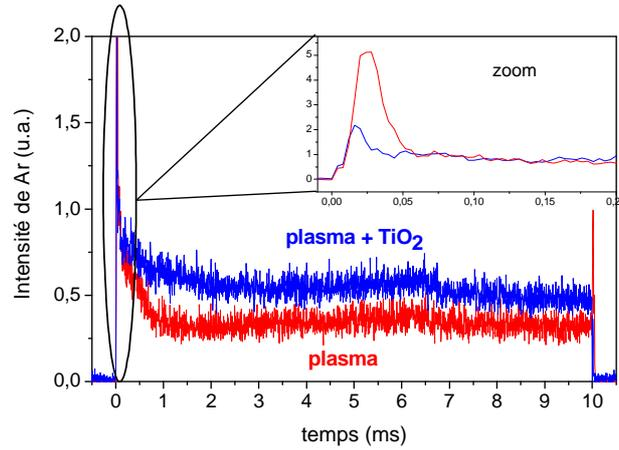
**Fig 21 : signal de la raie d'Ar avec et sans TiO<sub>2</sub> pendant un pulse de 10 ms. La partie supérieure droite montre un agrandissement de la phase d'amorçage.**
