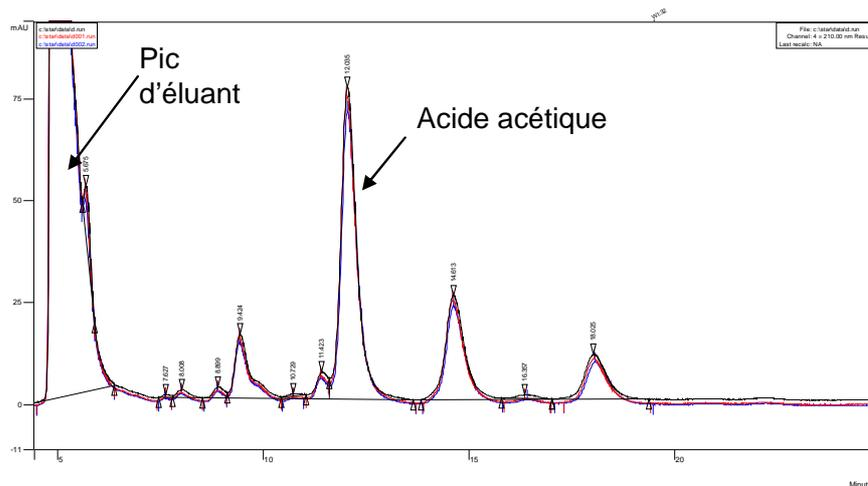
**Fig 15 : exemple de chromatogramme obtenu sur les acides extraits de la surface du catalyseur. Les différentes couleurs correspondent à l'analyse de plusieurs échantillons exposés dans les mêmes conditions de plasma**
