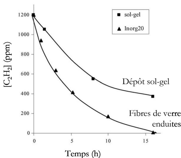
**Fig 6 : comparaison de l'efficacité de destruction photocatalytique du C<sub>2</sub>H<sub>2</sub> (concentration initiale 1200 ppm) par le dépôt sol gel du LACE et par le tissu Ahlström (fibres de verre + 20g/m<sup>2</sup> de particules de SiO<sub>2</sub> + 20 g/m<sup>2</sup> de particules de TiO<sub>2</sub>) [Thévenet 06]**
