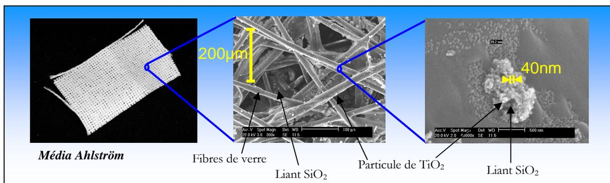
**Fig 4 : photographie du tissu de fibres de verre sur lequel sont déposées les particules de  $\text{TiO}_2$  (anatase, 40 nm) et  $\text{SiO}_2$  (20 nm environ) visibles sur les agrandissements à deux échelles différentes obtenus avec un MEB**
