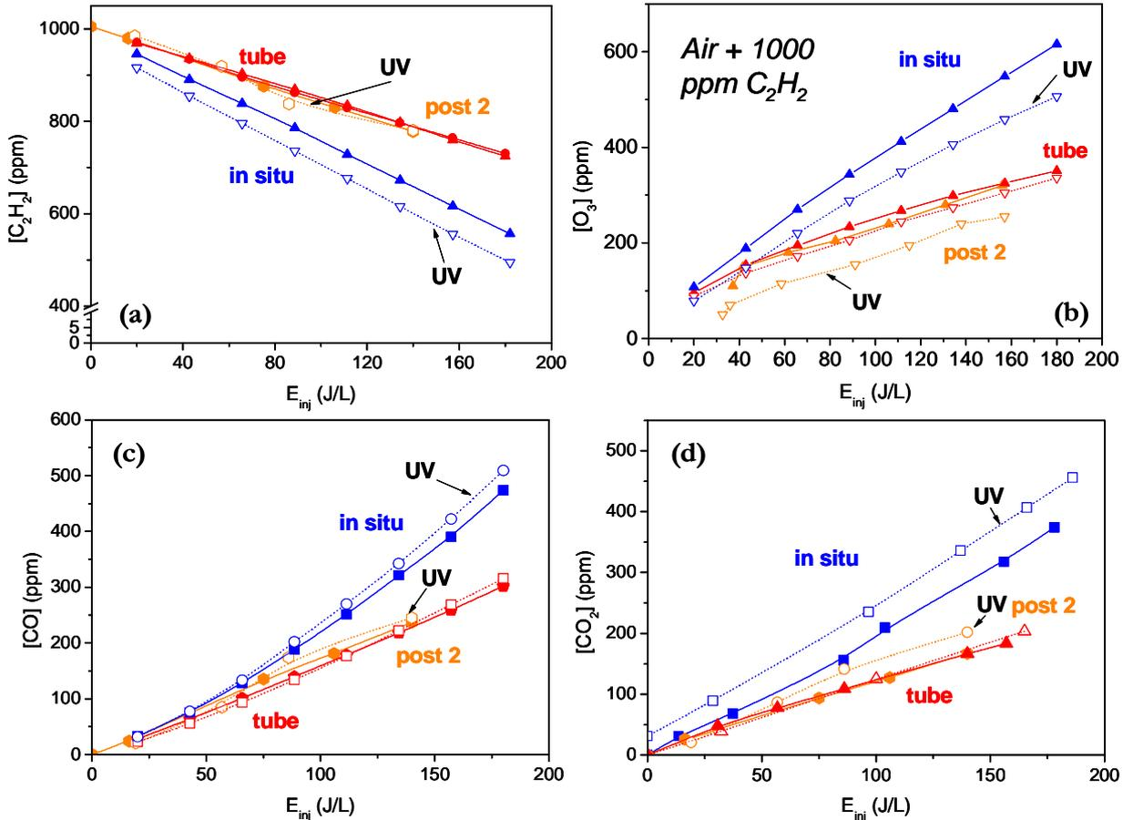
Fig 38 : mesures de  $C_2H_2$  (a),  $O_3$  (b),  $CO$  (c) et  $CO_2$  (d) sans matériau et avec  $Si_2O/Ti_2O$  in situ ou en post décharge (2s après la décharge) avec et sans UV externes.
