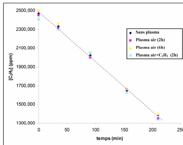
**Fig 1 : Dégradation photocatalytique de  $\text{C}_2\text{H}_2$  sur les couches minces déposées sur lame de verre par dip-coating, prétraitées ou non par plasma dans la DBD plan/plan à 0,22 W dans l'air pendant 2 h, pendant 6h ou dans l'air avec 3000 ppm de  $\text{C}_2\text{H}_2$  pendant 2 h. [Thévenet 06]**
