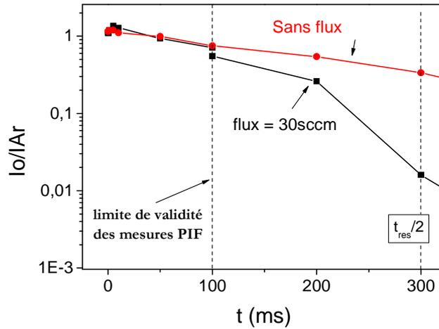
**Fig 10 : comparaison du rapport des intensités lumineuses de l'oxygène et de l'argon avec et sans flux de gaz. (O<sub>2</sub> pur, P=1,6 Torr, φ = 30 sccm ou 0, D = 5 ms, F = 1 Hz). Temps de résidence du gaz = 600 ms**
