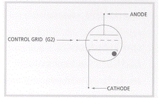
**Fig 20 : schéma de principe du thyatron**
